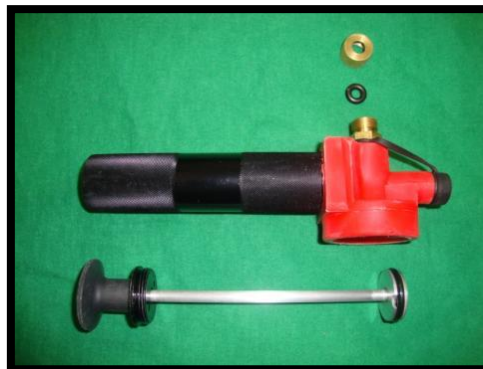
Figura 3.6: despiece de la bomba de succión.
