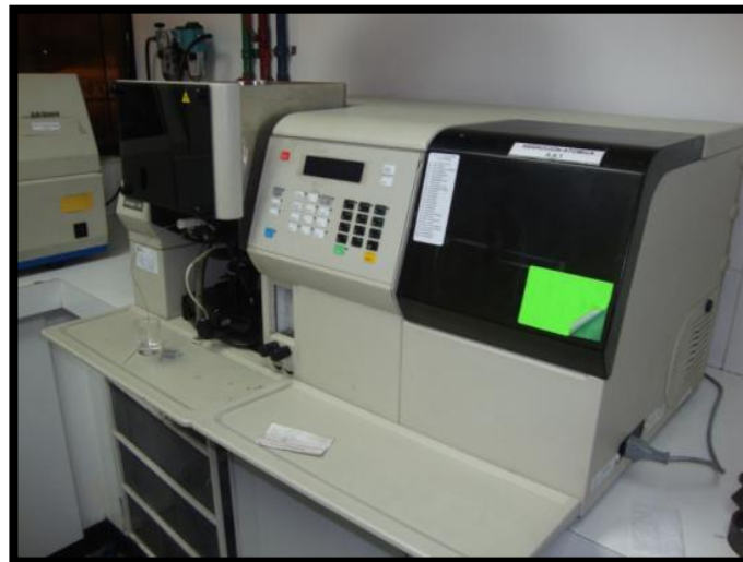
Figura 2.9: Espectrómetro de Absorción Atómica.
