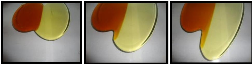
Figura 1.3: Diferencia en la viscosidad de dos aceites de transmisión.
