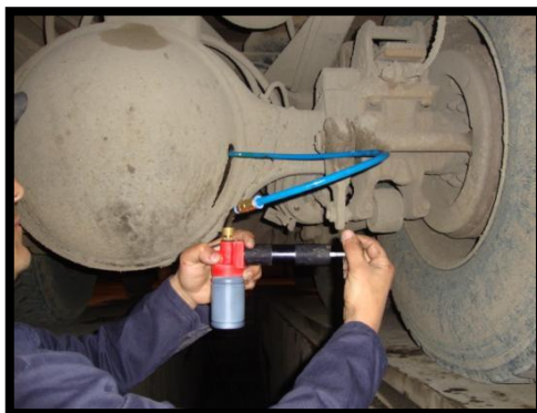
Figura 3.11: bombeado de aceite del diferencial.
