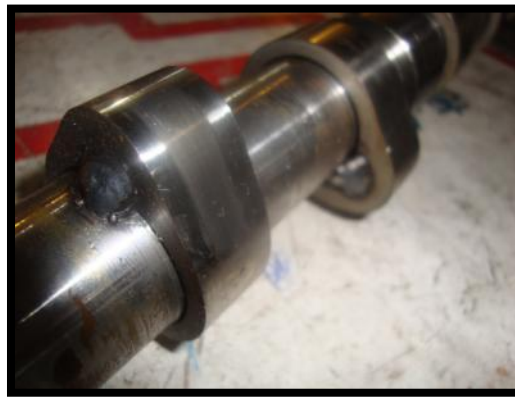
Figura 2.16: Desgaste normal en levas de admisión y escape.
