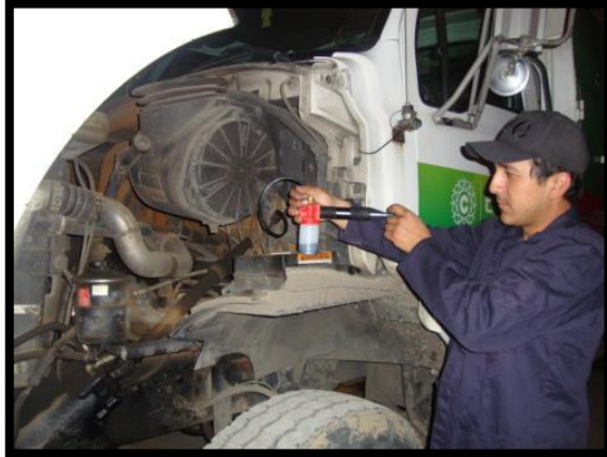
Figura 3.10: Bombeado de aceite de motor.
