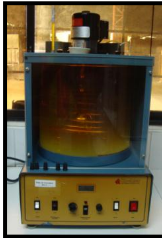
Figura 2.1: Máquina de baño termostático.
