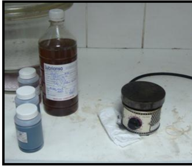
Figura 2.7: Plancha para prueba de chisporroteo.
