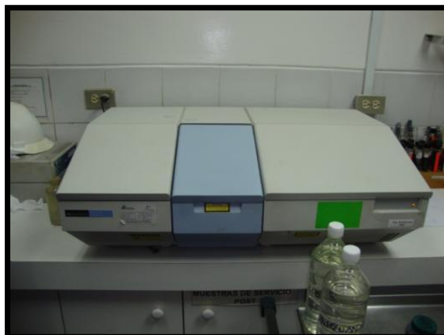
Figura 2.3: Scan Infrarrojo. Fuente: Foto Autor, laboratorio Lubrival S.A.
