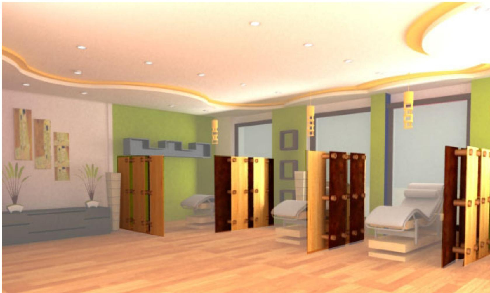
La tabiquería usada es diseñada con cartón corrugado ensamblado y prensado, con un acabado usando materiales del medio del mercado comercial, como chapa de madera; se encuentra instalada con tubos de cartón.
