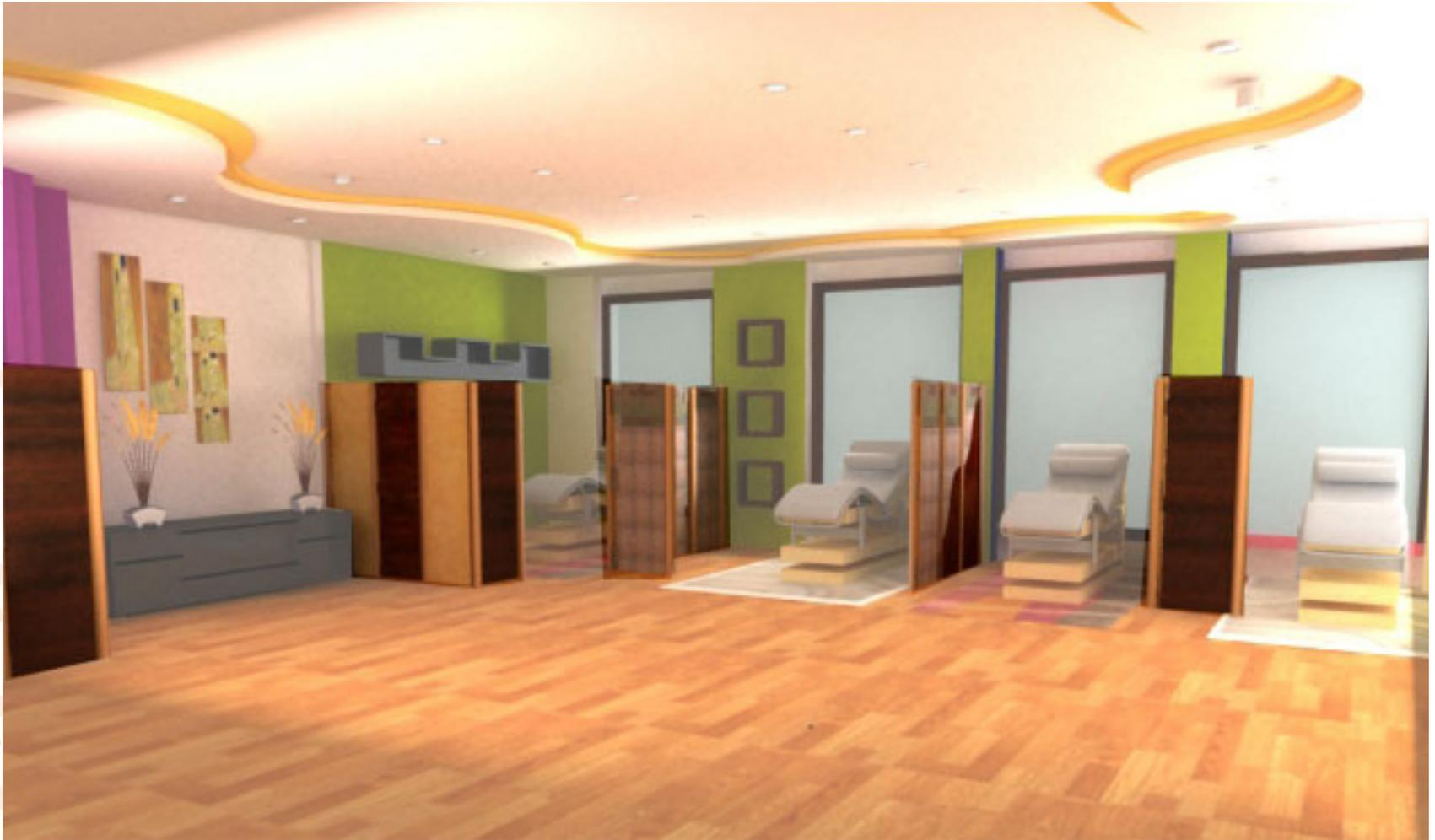
La tabiquería usada es diseñada con cartón corrugado ensamblado y prensado, con un acabado usando materiales del medio del mercado comercial, como Tinte de madera.
