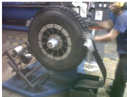
Figura 2.26 Colocación de la banda
