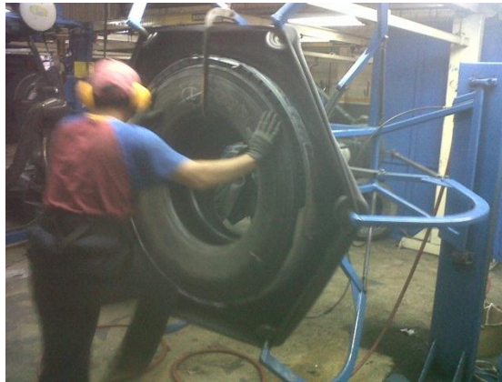
Figura 2.30 Colocación de sobre rin 22.5
