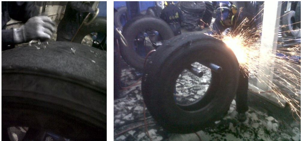
Figura 2.20 Estación de escavado
