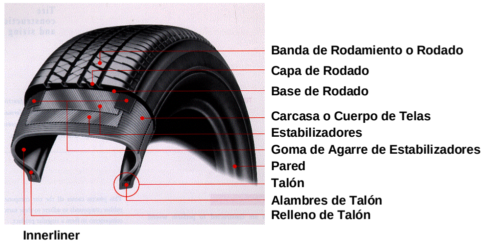
Figura 1.7 Partes del neumático
