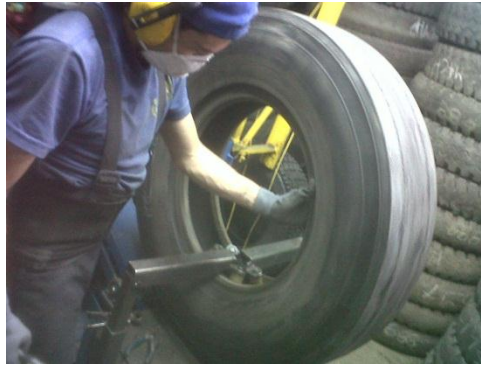
Figura 2.17 Estación de inspección inicial
