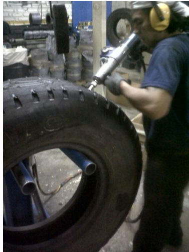
Figura 2.25 Estación de rellenado
