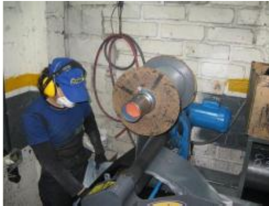
Figura 2.13 Colocación de cushion (HD30)
