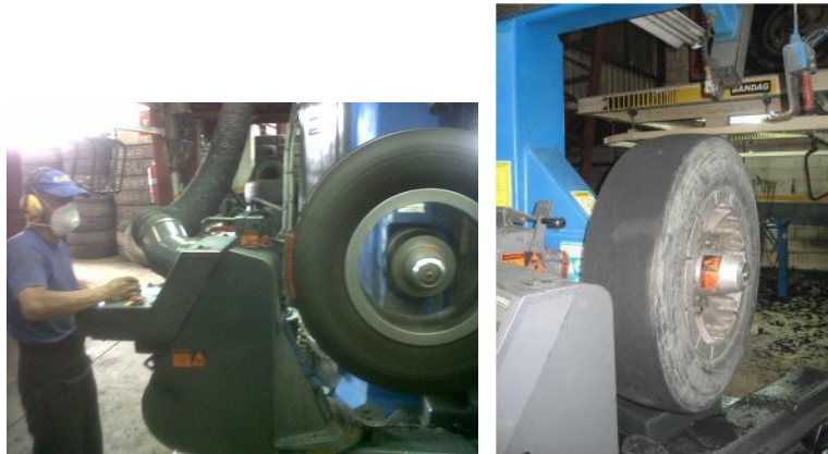
Figura 2.18 Estación de raspado
