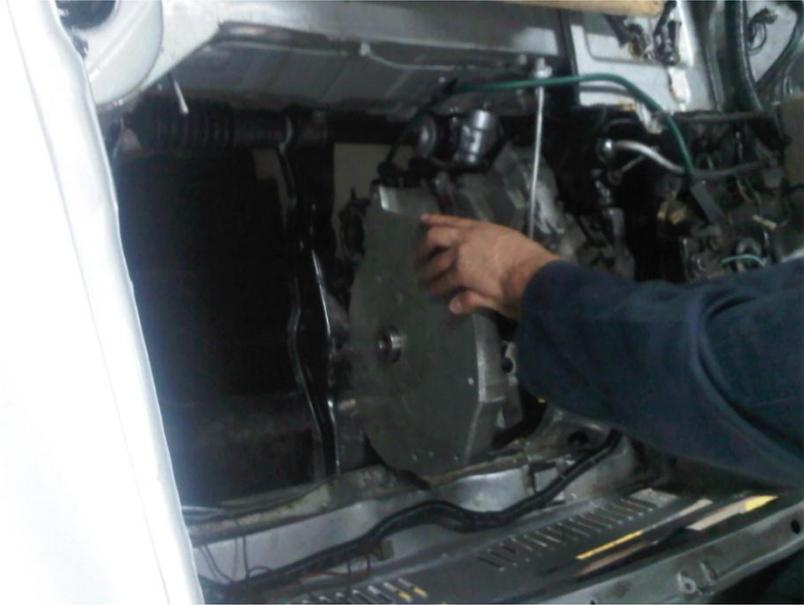
**Foto 10. Acople de la placa de Aluminio en el Motor**
