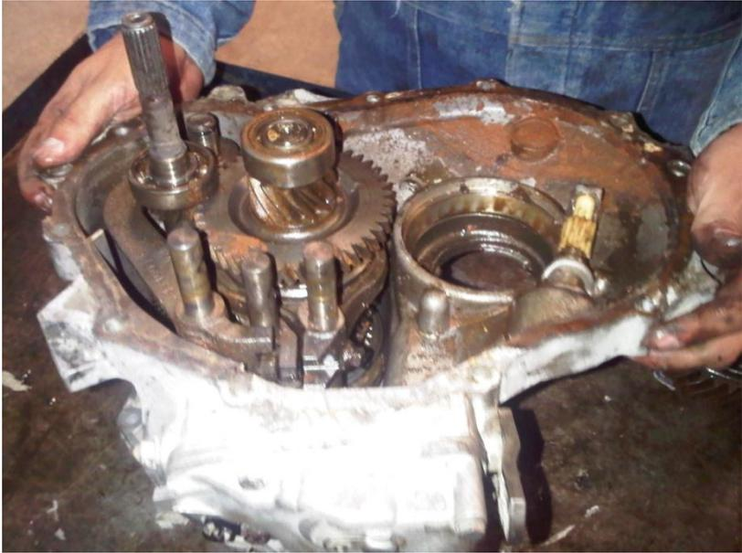
**Foto 5. Limpieza y Mantenimiento de la Caja de Cambios**
