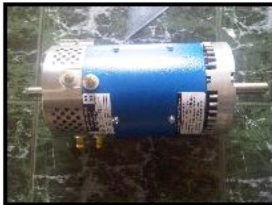
Como podemos ver en la GRÁFICO 3.9 de la curva de torque del motor eléctrico proporcionada por el fabricante, a medida que aumentamos las rpm el torque va disminuyendo, es decir el mayor torque entregado por el motor es utilizando éste a bajas rpm en arranque específicamente o en pendientes pronunciadas, en cambio cuando el VE alcanza velocidad o está en altas rpm el torque tiende a disminuir alcanzando un mínimo de 2,69 Nm.
