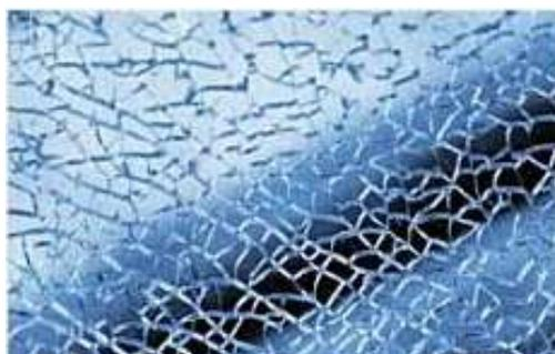
**Figura 3.15** Rotura de vidrio templado.
