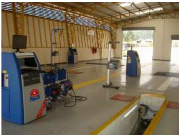
**Figura 2.11** Área de ubicación del opacímetro y analizador de gases.
