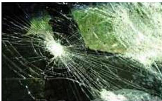
**Figura 3.16** Rotura de vidrio laminado.
