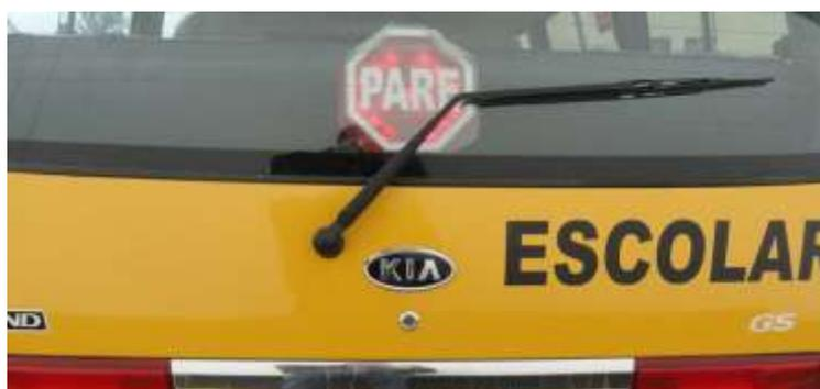
**Figura 2.8** Aviso luminoso instalado en buseta de uso escolar.
