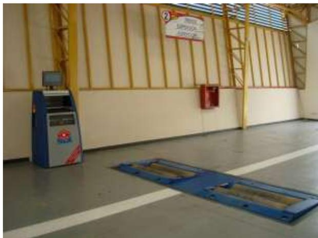
**Figura 2.10** Área de ubicación del frenómetro para pruebas dinámicas.
