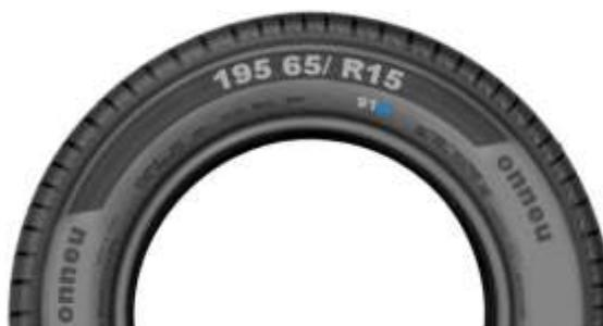
**Figura 3.10** Neumático con denominación radial.
