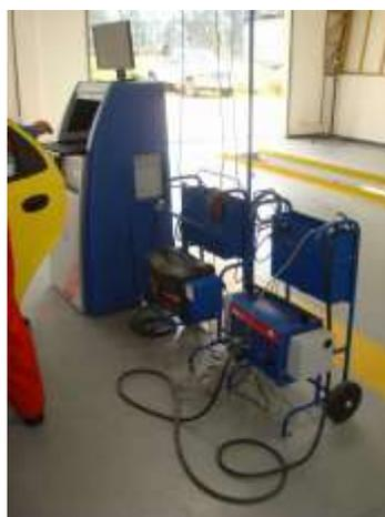
**Figura 2.12** Computadora programada para opacímetro y analizador de gases.
