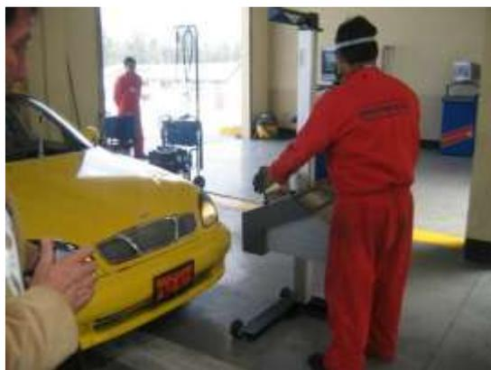
Figura 2.9 Control del reglaje del sistema de iluminación.
