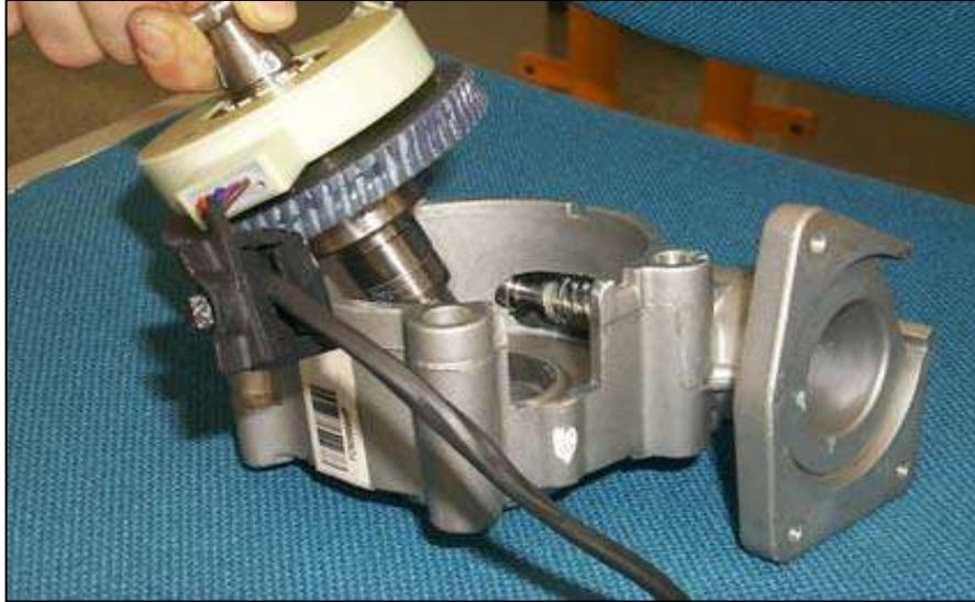
**Figura 1.2** Fotografía de los engranes del motor eléctrico
