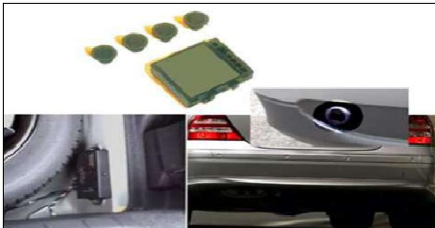
**Figura 2.2:** Ubicación del sensor ultrasónico en el vehículo
