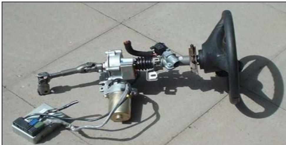
**Figura 2.10:** Dirección asistida eléctricamente de un corsa Opel.
