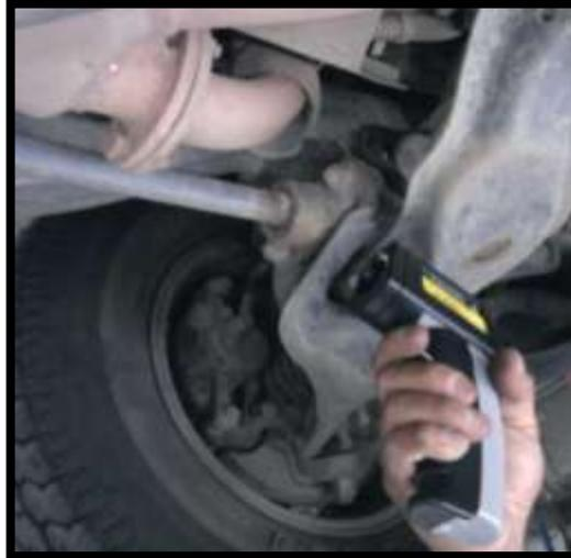
**Figura 3.1:** Medición de temperatura de gases
