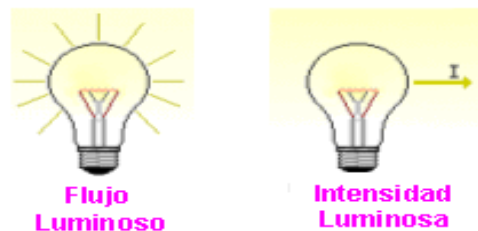
Figura 1.40: Diferencia entre flujo luminoso e intensidad luminosa
