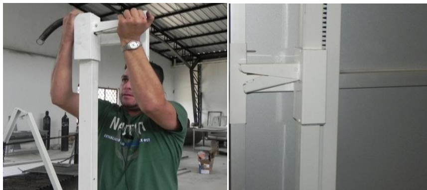
Figura 3.17: Montaje del Sistema de desplazamiento vertical y del tablero verificador
