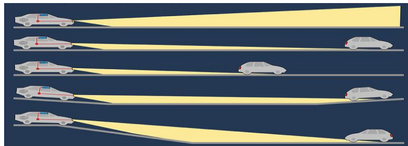
Figura 1.7: Sistema selectivo, detector de objetos potencialmente peligrosos
