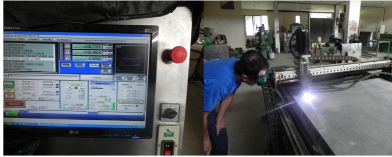
Figura 2.1: Pantógrafo, corte con CNC
