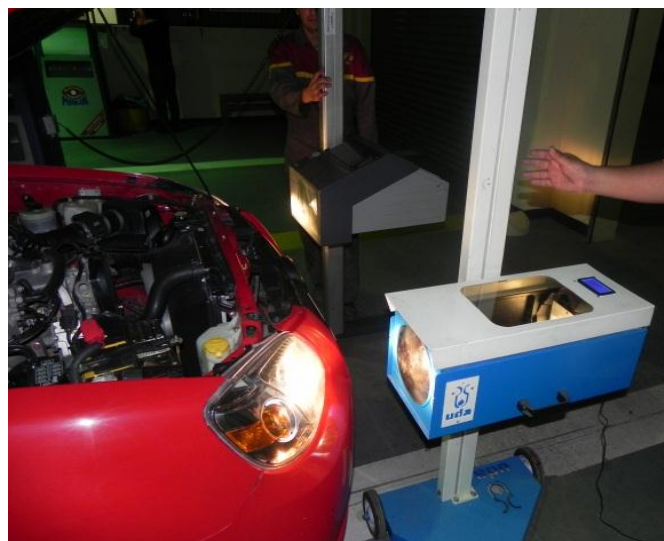
Figura 4.2: Homologación de luxómetro
