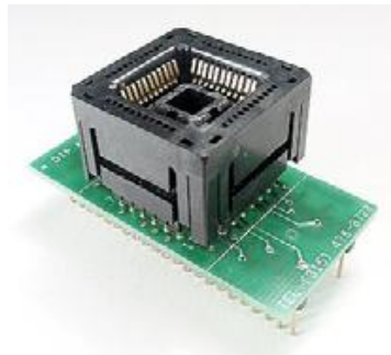
Fig. 1.13 Zócalo de lectura Memoria tipo PLCC.
