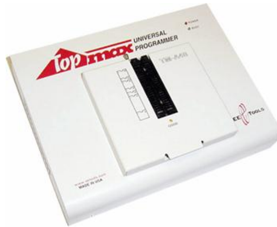
Fig. 1.8 Programador de banco.
