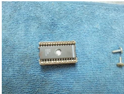
Fig. 3.5 Memoria EPROM del Vehículo Chevrolet Corsa
