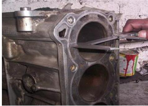
**Figura 2.1:** Medición del diámetro interior "D".
