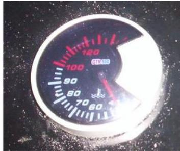
**Figura 3.41:** Indicador de temperatura del motor.
