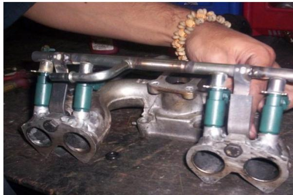
**Figura 2.18:** Riel de Inyección que se utilizara.
