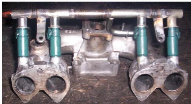
**Figura 3.14:** Ensamble de inyectores y riel en el múltiple.
