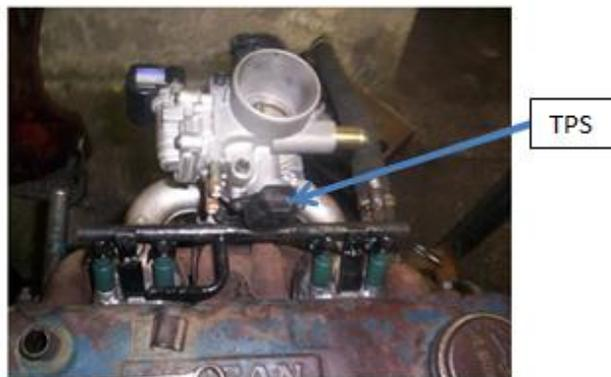
**Figura 3.22:** Adaptación sensor TPS.
