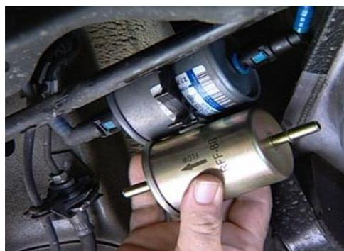
**Figura1.31:** Partes del Filtro de Combustible.
