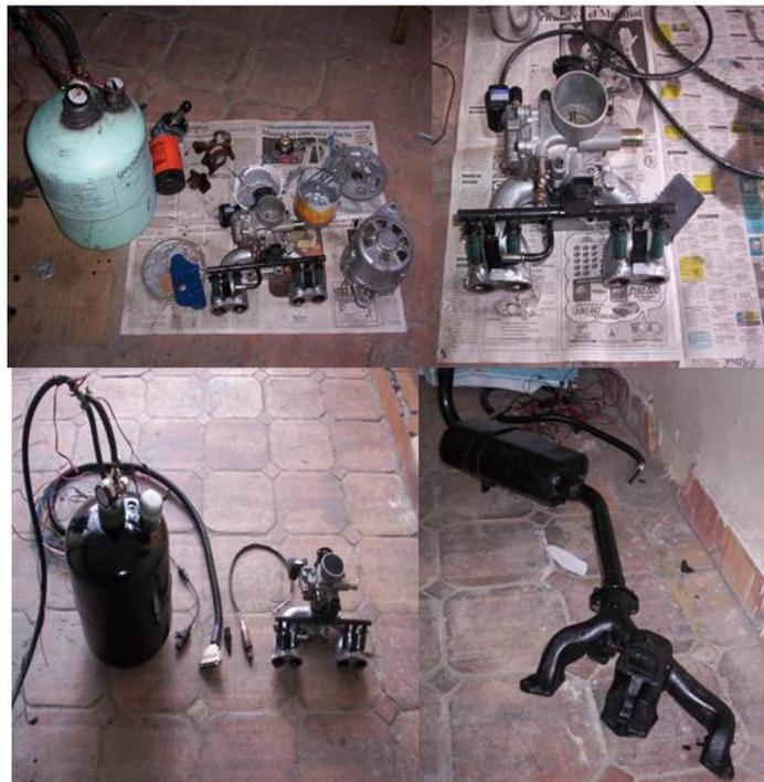
**Figura 3.12:** Limpieza y pintado de los componentes a adaptar.
