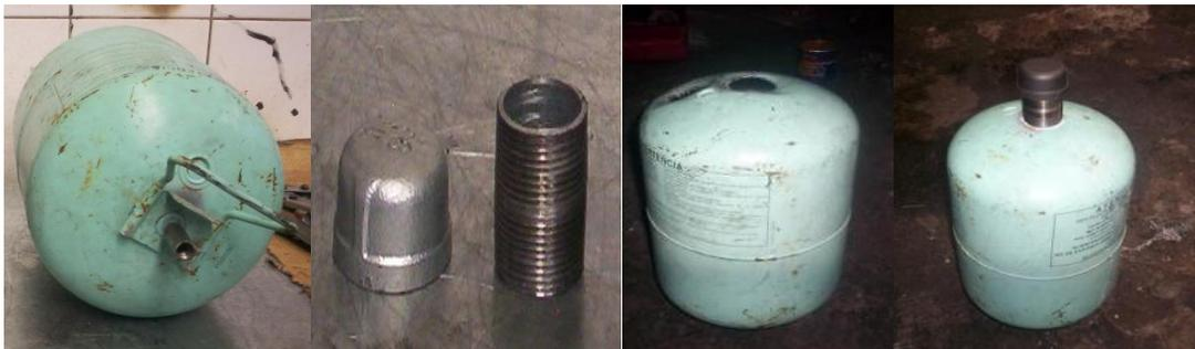
a) Tanque seleccionado      b) Tapón y tubo roscado      c) Agujeros para adaptar      d) Tanque ensamblado
