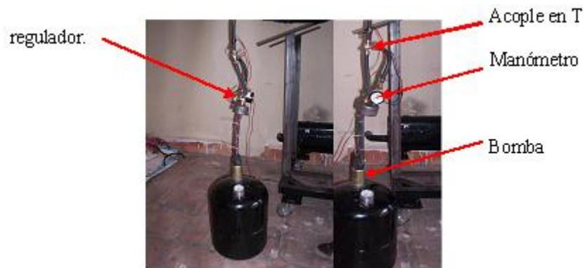
**Figura 3.10:** Adaptación de la bomba y regulador de combustible.
