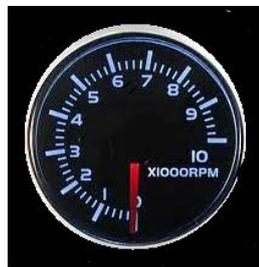
Figura 3.40: Tacómetro de rpms.
