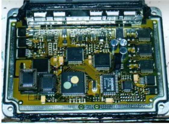
**Figura 1.7:** Estructura interna de la ECU del vehículo.
