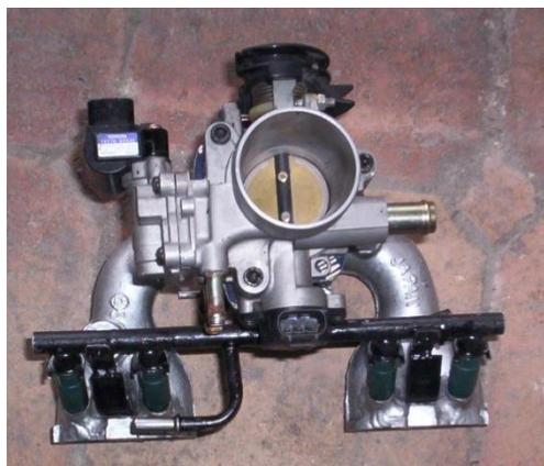
**Figura 3.15:** Cuerpo de alimentación ensamblado.
