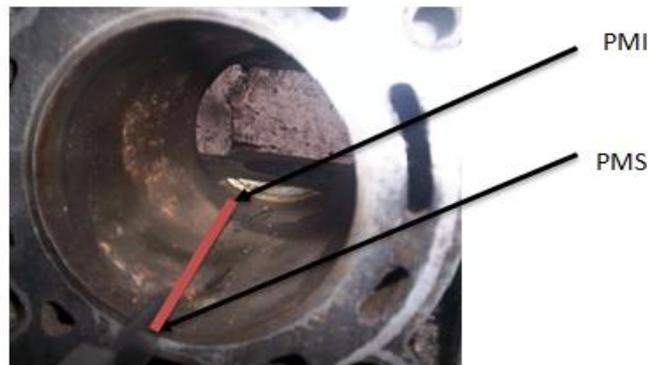
**Figura 2.2:** Medición de la carrera "L".
