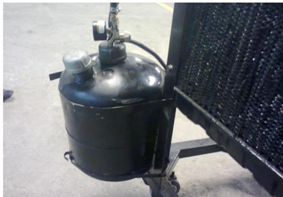
**Figura 3.17:** Adaptación del tanque de combustible.
