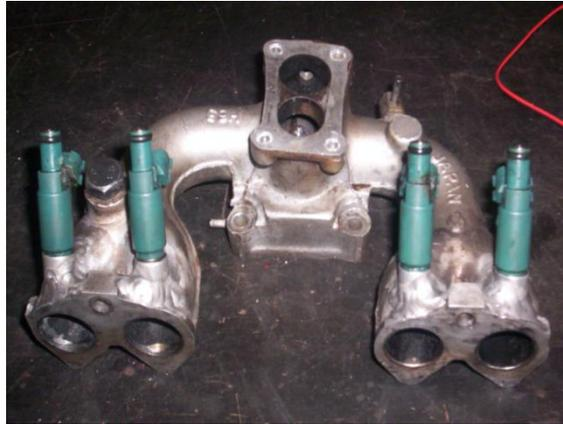
**Figura 3.13:** Ensamble de inyectores en el múltiple.
