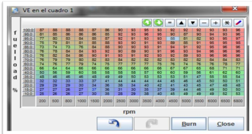
Figura 4.19: Tabla de reglaje de volumen de eficiencia.
