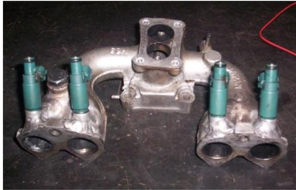
**Figura 2.15:** Inyectores seleccionados para la adaptación del Sistema MPFI.
