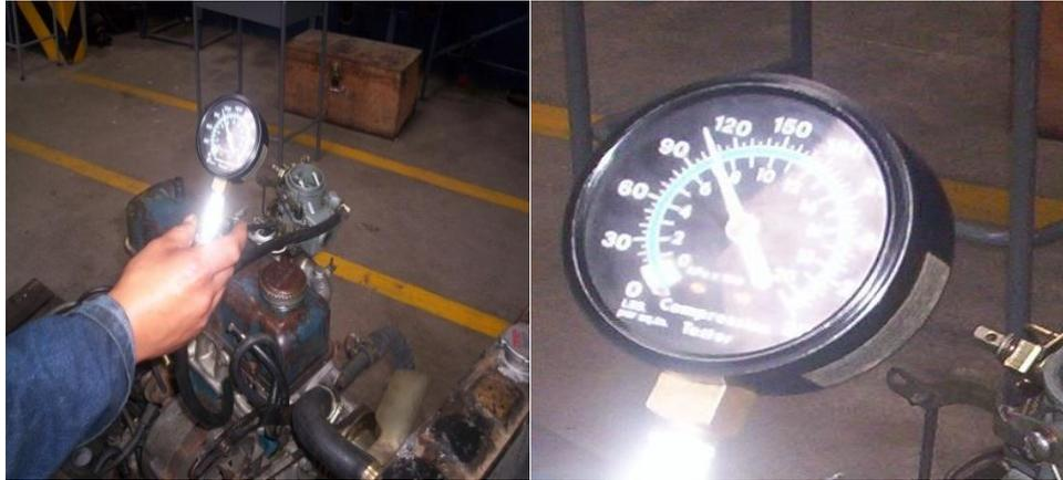
**Figura 2.4:** Medición de compresión.
