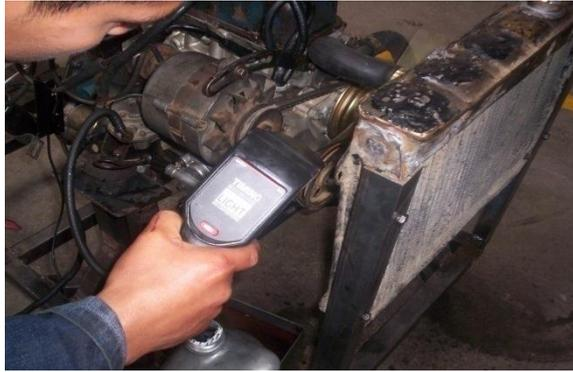
**Figura 2.5:** Medición de rpms
