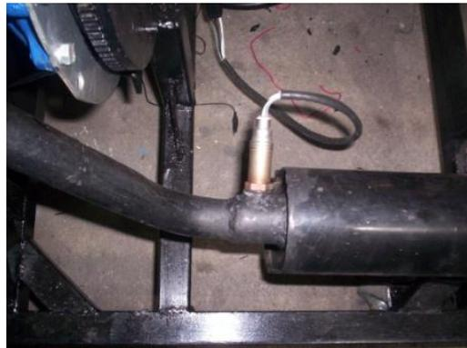
**Figura 3.21:** Adaptación sensor de oxígeno.
