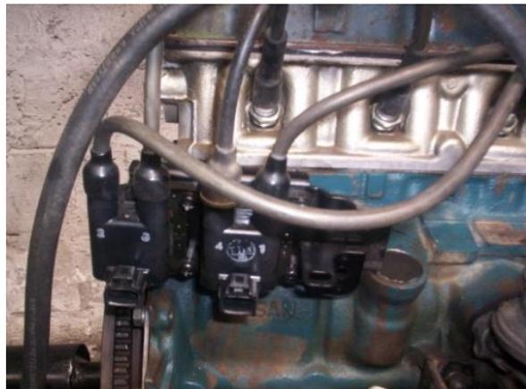
**Figura 3.23:** Acople de la bobina de encendido.
