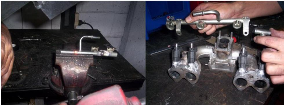
Figura 3.6: Adecuación del riel de inyectores.
