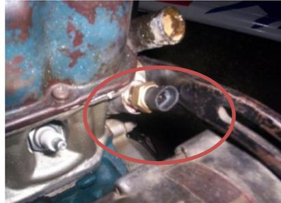
**Figura 1.19:** Ubicación del sensor CTS en el motor.
