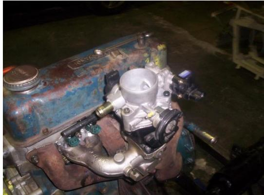
**Figura 3.16:** Adaptación del Cuerpo de alimentación en el motor.
