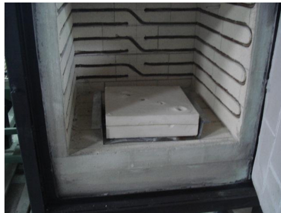
Figura 3. 52 Pre calentamiento del molde
