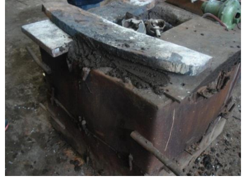
Figura 3. 20 Aislamiento del horno
