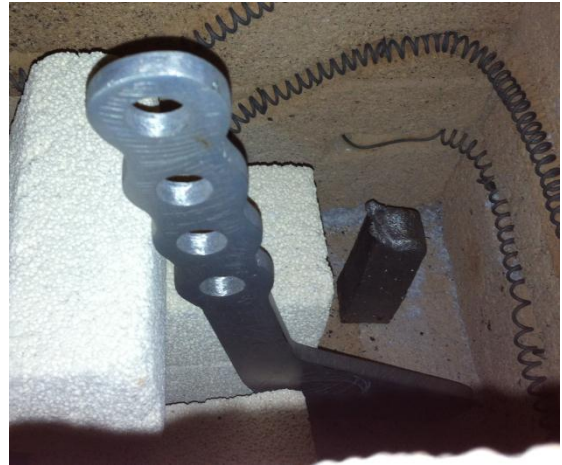
Figura 4. 6 Palanca y probeta dentro del horno para tratamiento de solución
