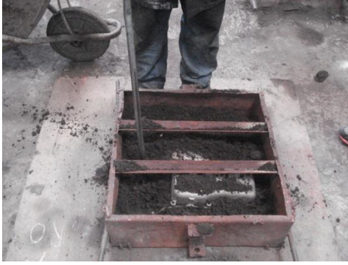
Figura 3. 12 Compactado de arena
