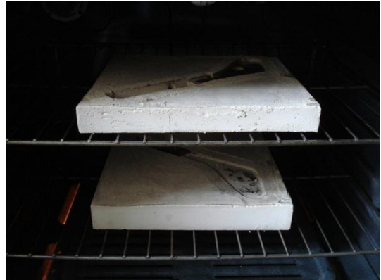
Figura 3. 49 Molde dentro del horno durante el proceso de secado
