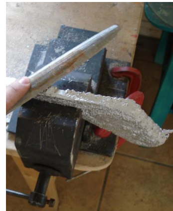
Figura 3.58 Limado de bordes y asperezas
