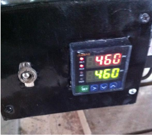
Figura 4. 5 Programación del horno a 460 °C de temperatura.
