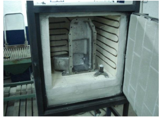
Figura 4.2 Cárter dentro del horno de tratamientos térmicos previo al tratamiento.
