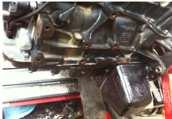
Figura 4. 32 Prueba de fugas con el motor en posición inclinada.
