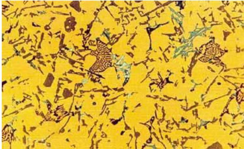
Figura 4. 19 Aleación de aluminio-silicio perteneciente a un pistón. (European Aluminium Association, 7)
