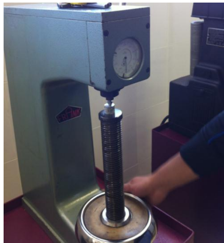
Figura 4. 26 Medición de dureza de una probeta en el durómetro Brinell
