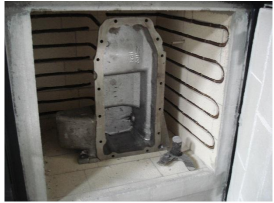
Figura 4. 3 Cáster y probeta listos, después de 8 horas de duración del tratamiento de envejecido.
