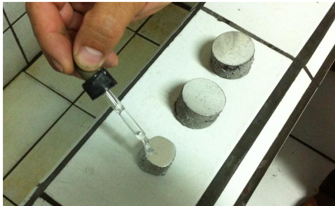
Figura 4. 10 Probetas sometidas al reactivo.
