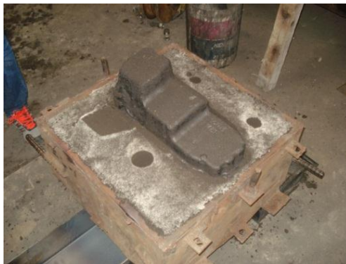
Figura 3. 17 Terminado tapa superior.
