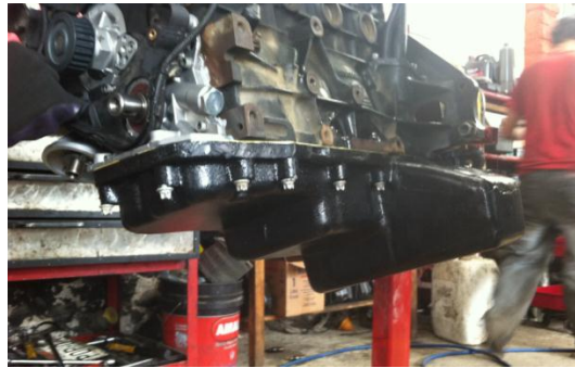
Figura 4. 31 Prueba de fugas con el motor en posición vertical.
