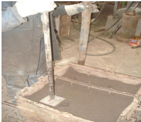
Figura 3.17 Colocación conductos de vaciado.
