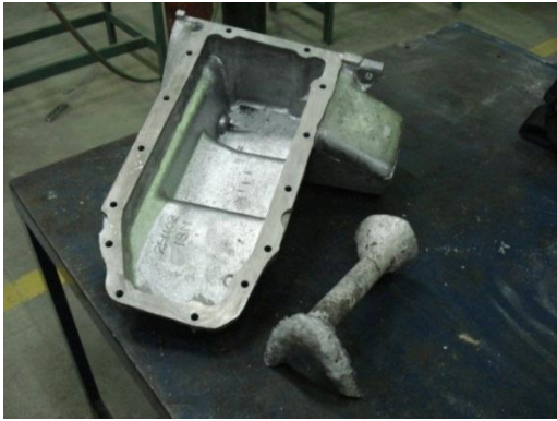
Figura 4.1 Cárter y probeta listos, antes del tratamiento de envejecido
