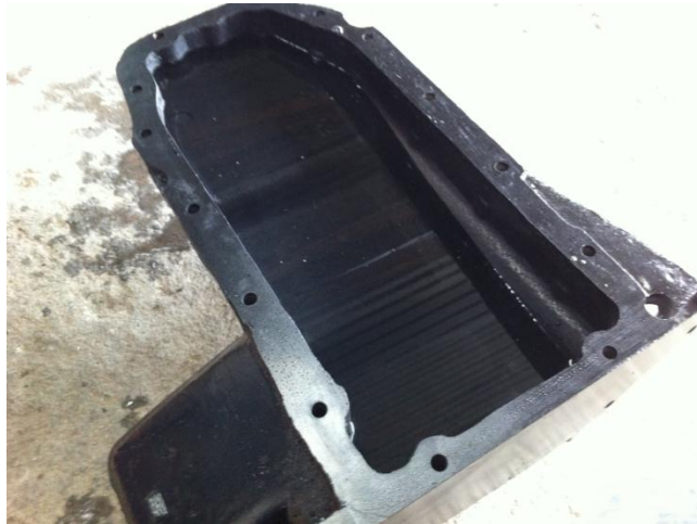
Figura 4. 28 Cárter completamente lleno de agua para comprobar estanqueidad y trizaduras
