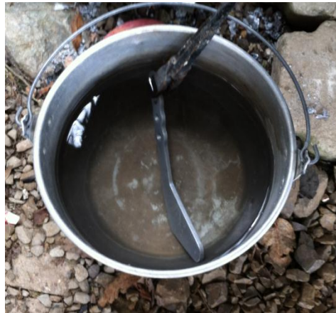
Figura 4. 7 Templado de la palanca en agua.
