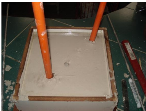
Figura 3. 46 Colocación de tubos para los orificios de colado
