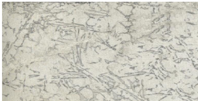
Figura 4. 12 Aleación 380, fundición, contiene en su estructura partículas de silicio y cobre (ASM Committee on Metallography of Aluminum Alloys, 262)
