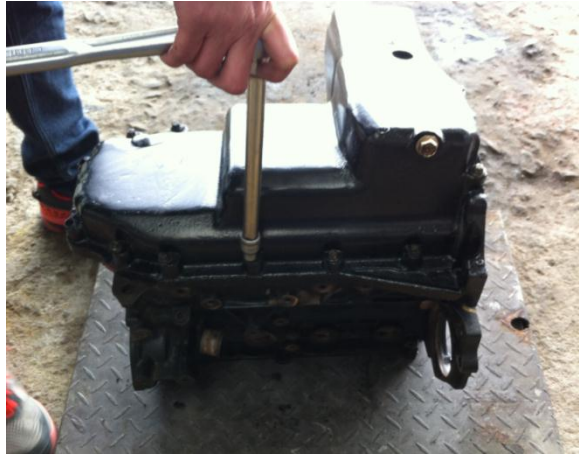
Figura 4. 29 Ajuste y calzado de los pernos entre el cárter y bloque.
