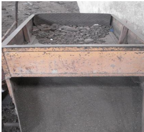
Figura 3. 6 Tamizado de la arena.
