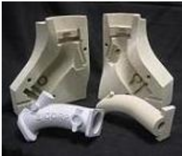
Figura 3. 5 Moldes de yeso (3D Systems http://www.zcorp.com/es/Solutions/Castings--Patterns--Molds/spage.aspx , Acceso: 23 de marzo 2012)
