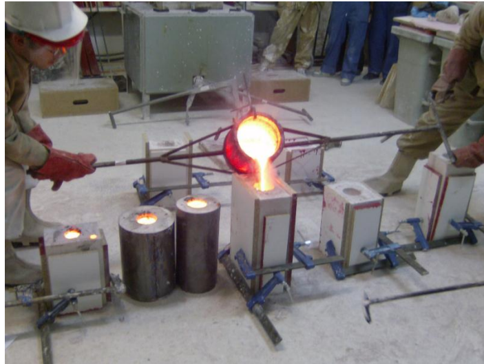
Figura 3. 1 Fundición por gravedad en moldes de yeso
