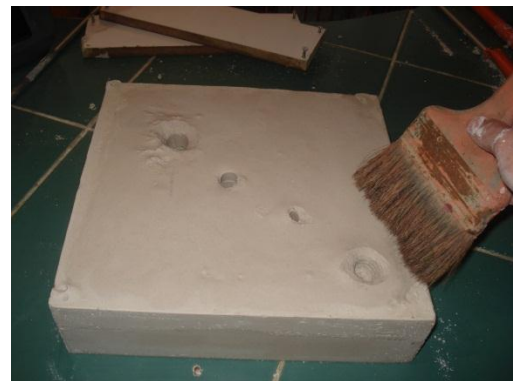
Figura 3. 47 Limpieza de molde.
