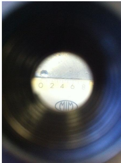
Figura 4. 27 Medición del diámetro de la huella con el amplificador de imagen.
