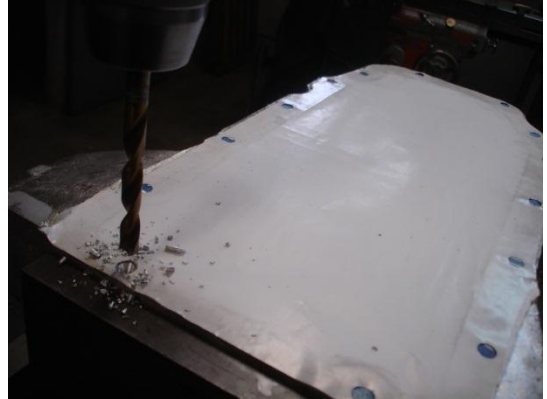
Figura 3. 31 Taladrado de agujeros en la superficie de asiento
