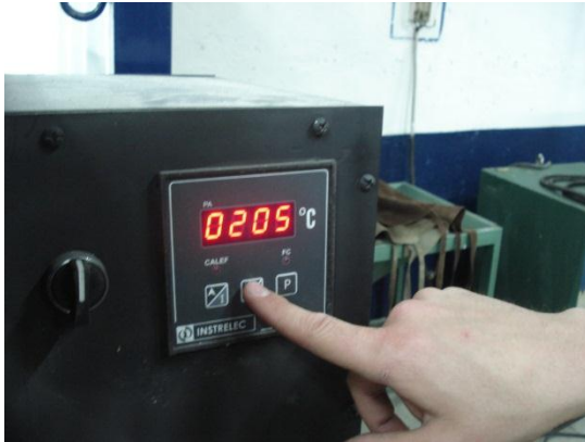
Figura 4. 2 Programación de la temperatura: 205 °C y tiempo del tratamiento térmico: 8 horas
