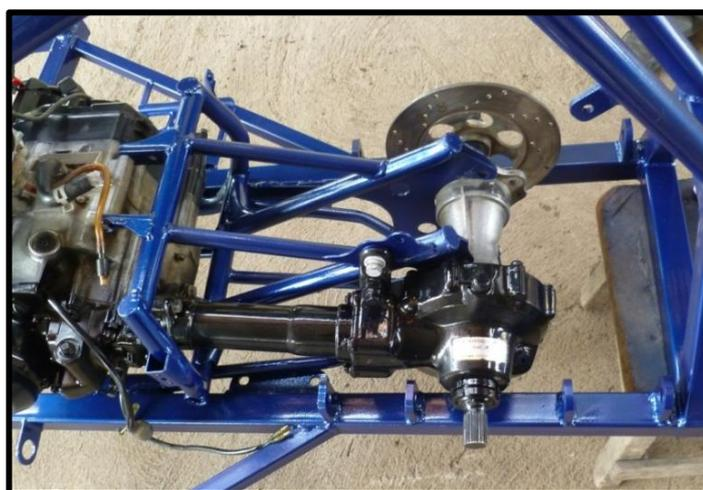
Fig. 3.33 Montaje de la corona de transmisión
