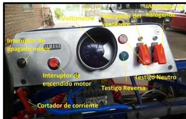
Figura 3.50 Montaje del tablero de instrumentos
