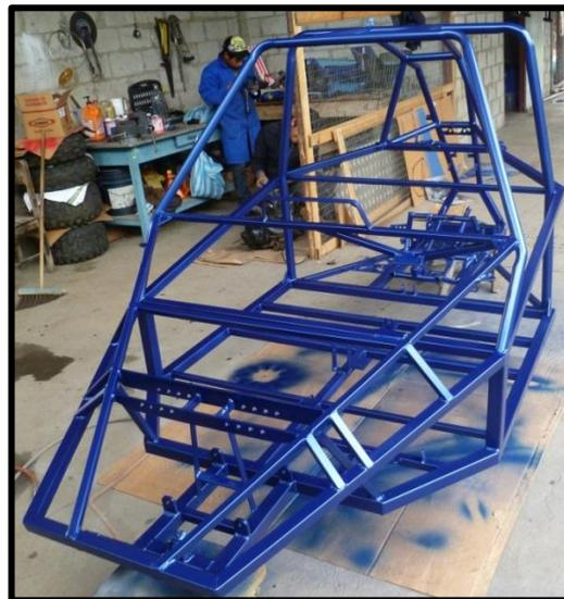
Figura 3.8 Pintado de la estructura
