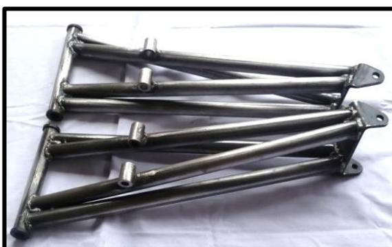
Figura 3.11 Platos de la suspensión delantera
