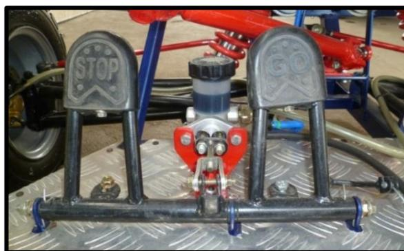
Figura 3.41 Montaje de pedales de accionamiento
