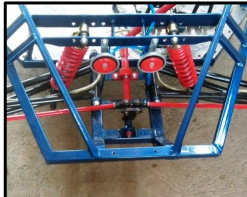
Figura 3.49 Montaje de pitos
