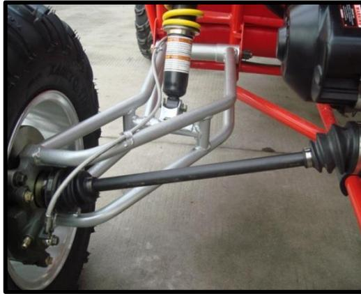
Figura 1.8 Eje de transmisión
