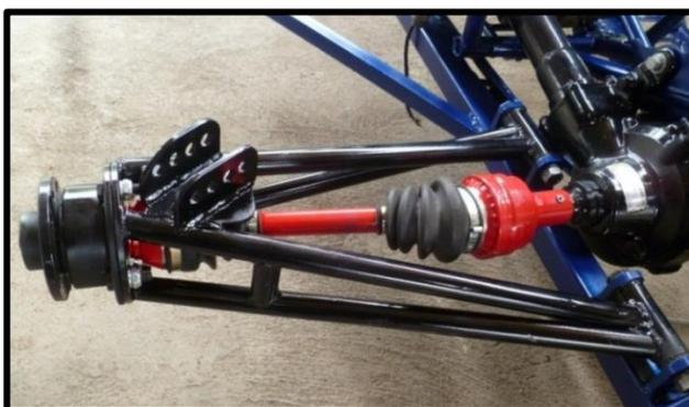
Fig. 3.34 Montaje de ejes y contra ejes de transmisión
