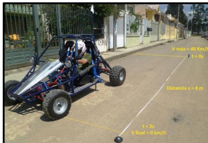
Figura 4.4 Comprobación de la distancia de frenado
