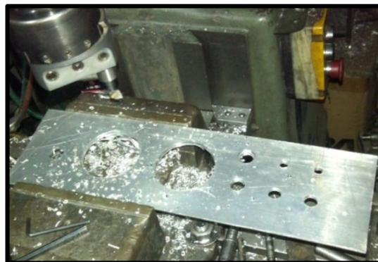
Figura 3. 29 Tablero de aluminio para instrumentos
