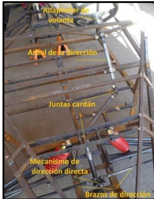
Figura 3.17 Mecanismo de dirección
