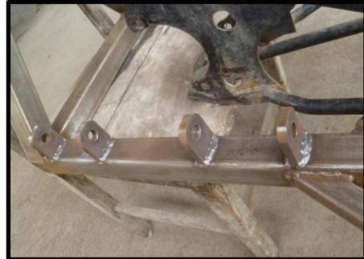
Figura 3.16 Soportes del plato de suspensión
