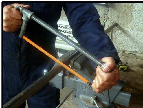
Figura 3.4 Corte manual con arco de sierra
