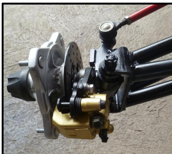
Figura 3.39 Montaje de mordazas delanteras
