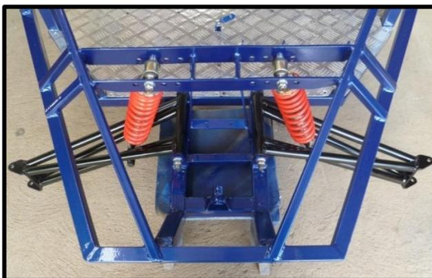
Fig. 3.35 Montaje de la suspensión delantera
