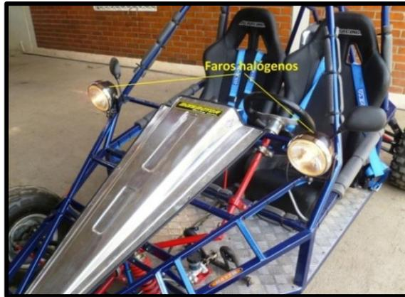
Figura 3.47 Montaje de halógenos
