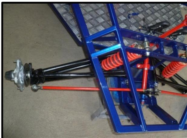
Figura 3.38 Montaje de pivotes y brazos de acoplamiento
