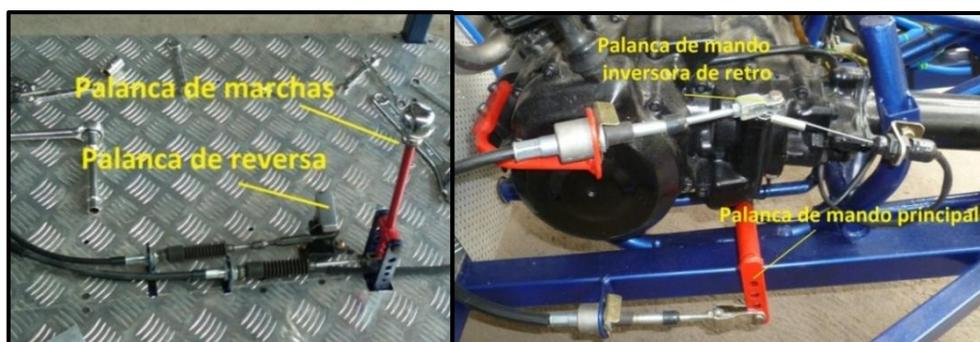
Figura 3.42 Montaje de palancas de cambios
