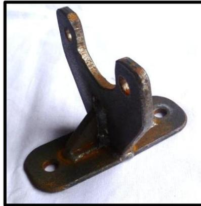
Figura 3.22 Soporte de la bomba de freno
