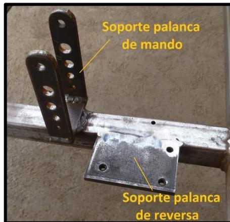
Figura 3.28 Soportes de las palancas de cambios
