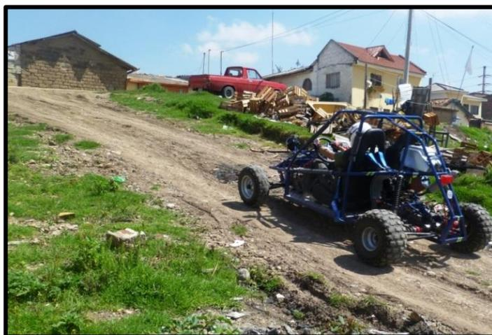
Figura 4.16 Comprobación de arranque en pendiente larga 20<sup>0</sup>
