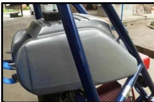
Figura 3.32 Montaje del tanque de combustible
