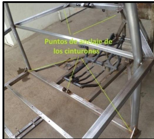
Figura 3.24 Anclaje para los cinturones de seguridad
