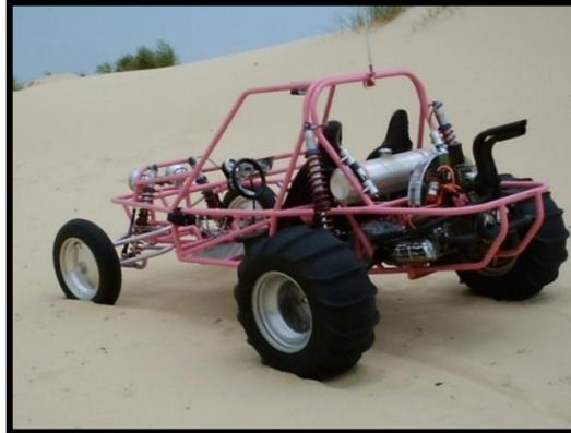
Figura 1.2 Vehículo Estructural Tubular
