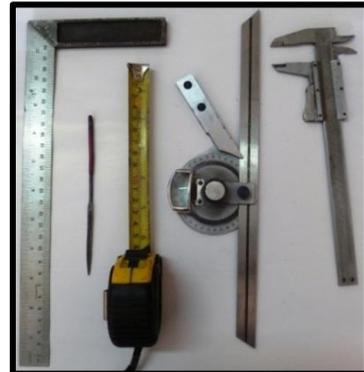
Figura 3.3 Instrumentos de trazado
