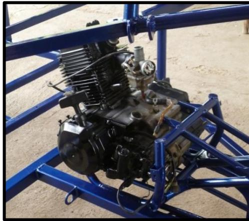
Figura 3.30 Montaje del motor
