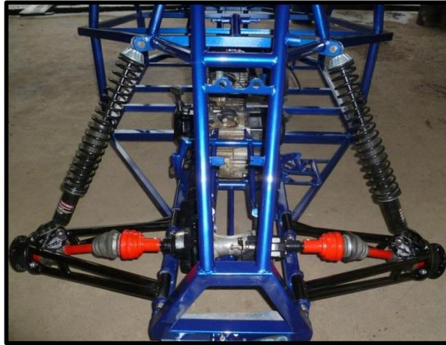
Figura 3.36 Montaje de la suspensión posterior
