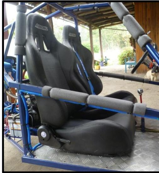
Fig. 3.43 Montaje de asientos
