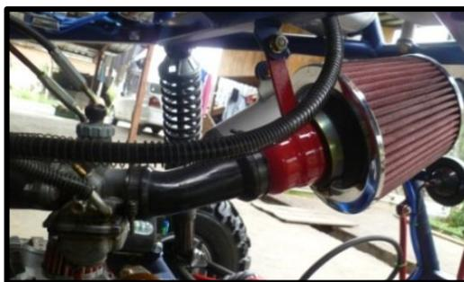
Figura 3.31 Montaje del depurador
