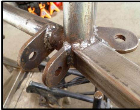
Figura 3.15 Soporte superior del amortiguador
