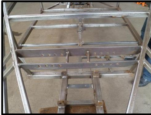
Figura 3.12 Soporte superior de los amortiguadores
