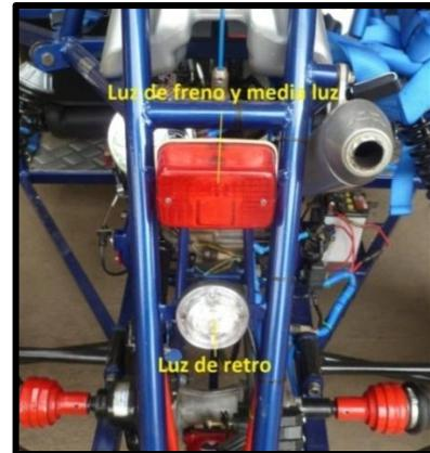
Figura 3.48 Montaje de luces de freno y retro
