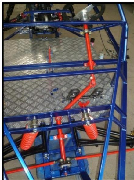
Figura 3.37 Montaje del árbol de dirección
