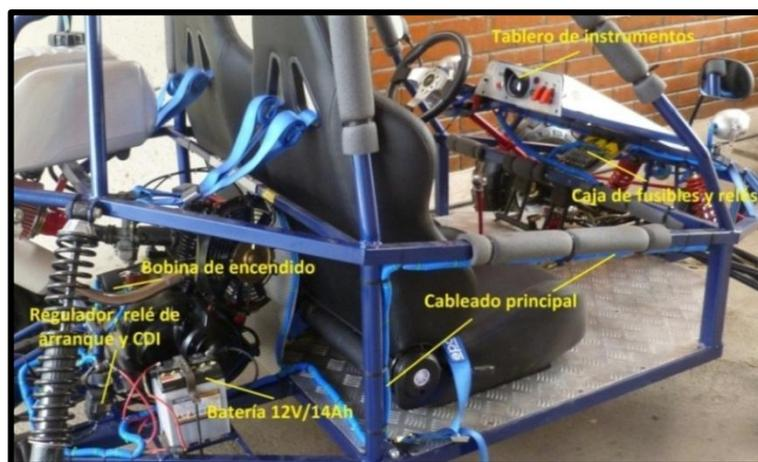
Figura 3.45 Montaje del cableado principal
