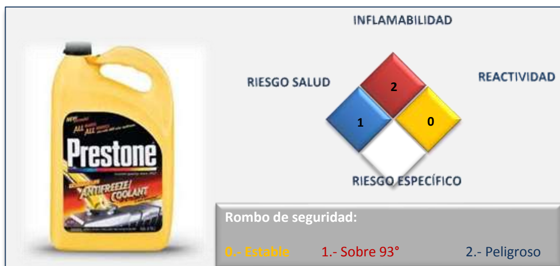
Figura 1. 2. Rombo seguridad Líquido refrigerante
