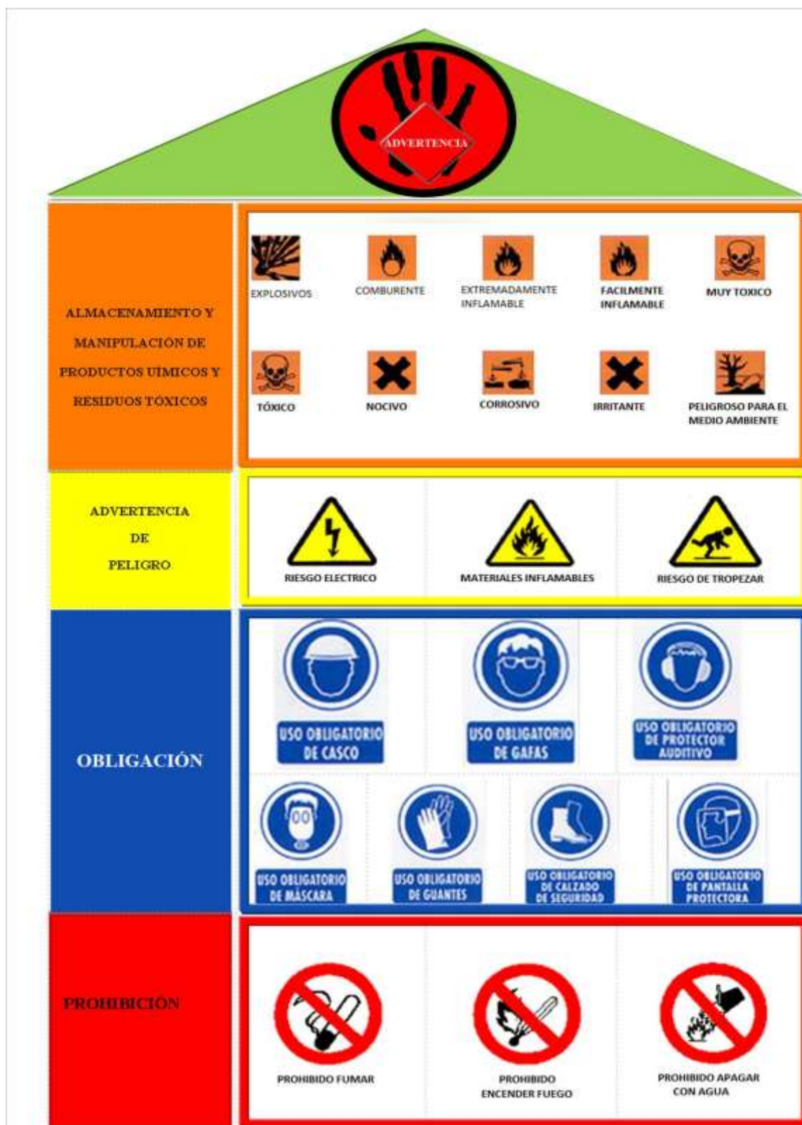
Figura 3.3. Panel de señalización de un taller automotriz
