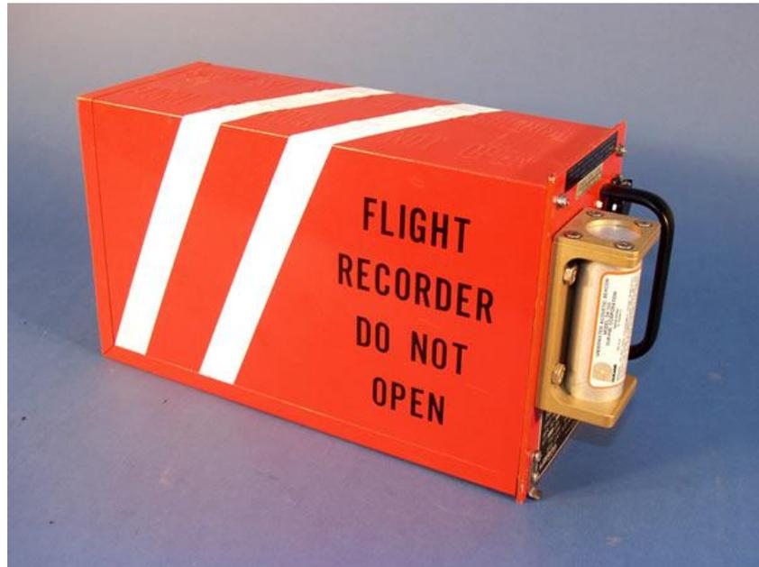
**Figura 2.** Cvr (cabinvoicerecorder) fuente: NTSB febrero 2012
