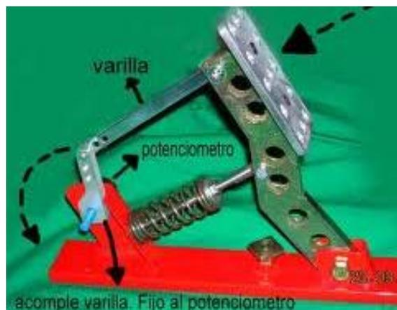
**Figura 5.** Esquema de un potenciómetro acoplado a un pedal
