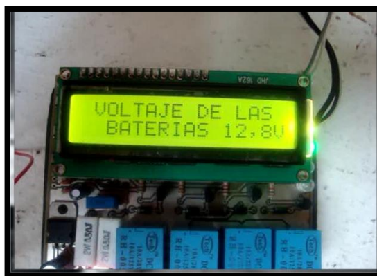
Figura 4.7.8: Cartel que indica el voltaje de la batería sin carga.
