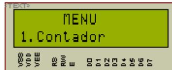
Para que el usuario sepa que opción está seleccionada, en cada interrupción por desbordamiento de TMR0 en la que no se presione ninguna tecla, una variable es incrementada, hasta llegar a 37, entonces la segunda fila de la pantalla es apagada; cuando la variable llegue a 64, se imprime nuevamente la segunda fila y la variable se
