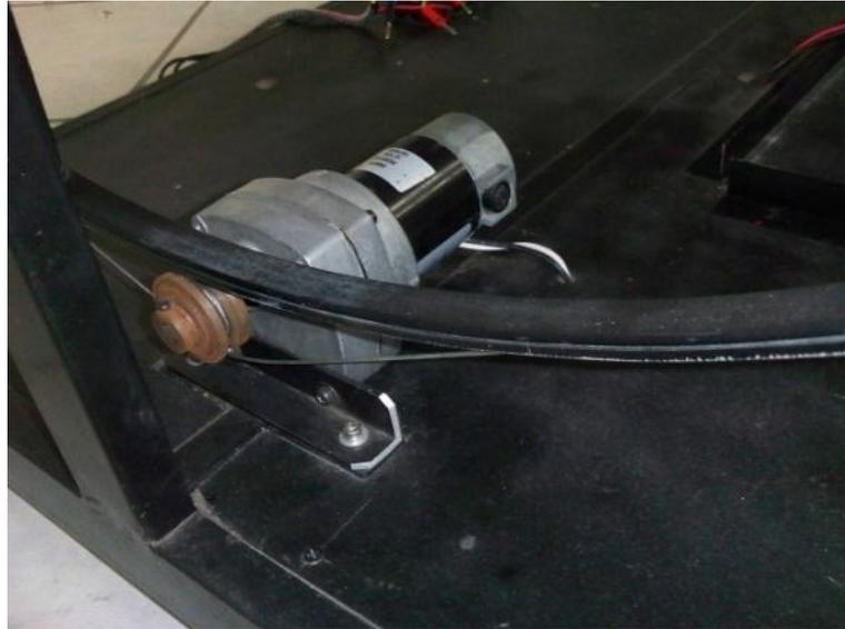
Figura 2.21. Motor de corriente continua colocado en la estructura metalmecánica
