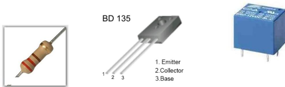
Figura 3.23. Resistencia de 320Ω, Transistor BD135, y Relé de 12V/10A.
