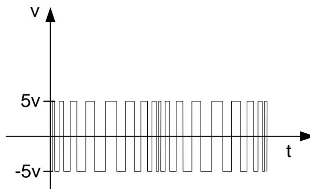
Figura 3.13. Señal de PWM a la salida del amplificador
