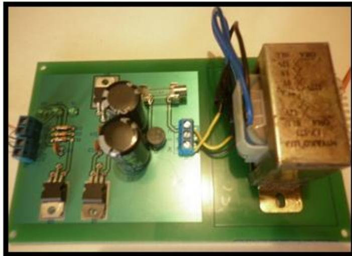
Fotografía 1: Placa construida de la fuente de alimentación.
