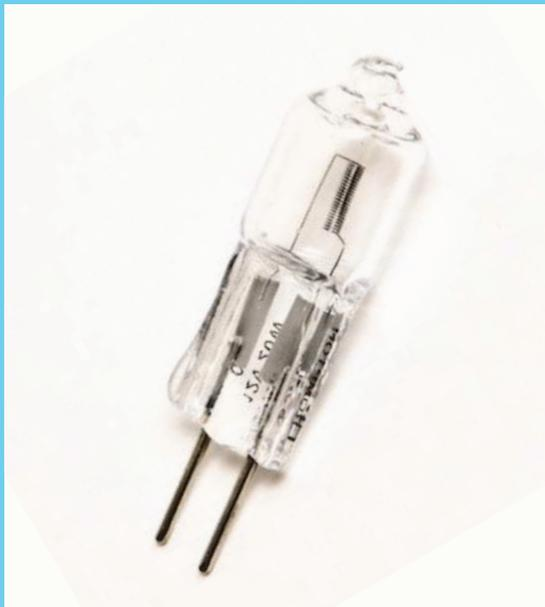
Las lámparas incandescentes halógenas de tungsteno, tienen un funcionamiento similar al de las lámparas incandescentes normales, con la salvedad de que el halógeno incorporado en la ampolla ayuda a conservar el filamento.
