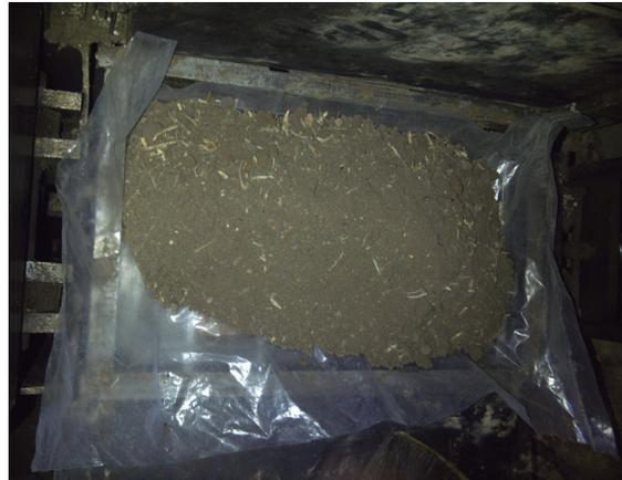
Aquí se puede observar como se coloca la mezcla de manera normal sobre el plástico para posteriormente ser prensado en la máquina.
