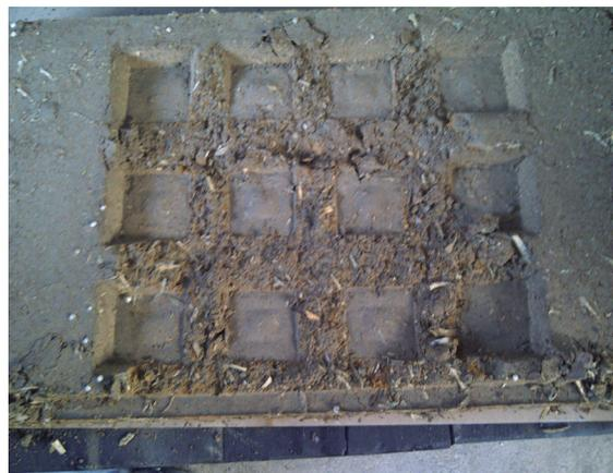
Imagen del panel desmoldado (cierta cantidad de material se queda en la plancha indicada anteriormente).
