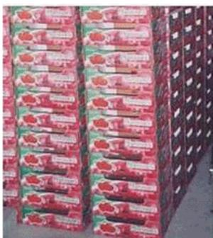
Las frutas pasan a una zona de cuarentena donde son clasificadas y envasadas en cajas de cartón corrugado con orificios laterales. El peso neto de cada caja es de 4.5 Kg.
