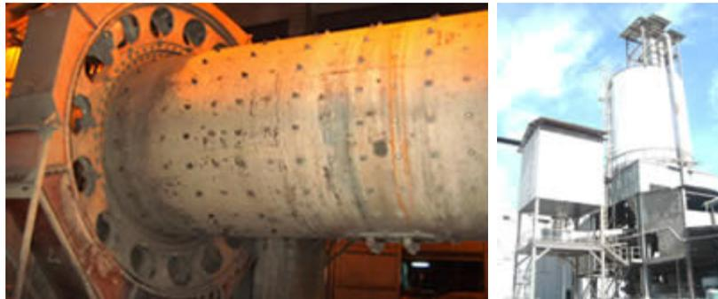
El molino tiene un diseño con descarga axial; es accionado por un motor eléctrico de 3000 HP, con una garantía de producción de 60 TMPH de cemento con una superficie específica media de 4300 cm<sup>2</sup>/g (blaines). La clasificación del producto se realiza mediante un circuito dinámico con un separador de partículas por aire marca F.L.Smith, modelo OSEPA.
