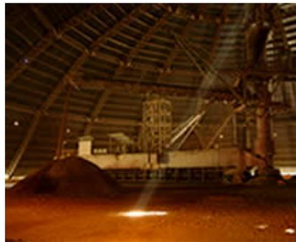
La maquinaria que realiza la prehomogenización está dentro de un almacén circular, marca Pohlíg – Heckel - Bleichert, que consta de un apilador con capacidad de 600 TPH, almacenando el material en dos pilas según el método Chevron y un recuperador con capacidad de alimentación de 200 TPH.
