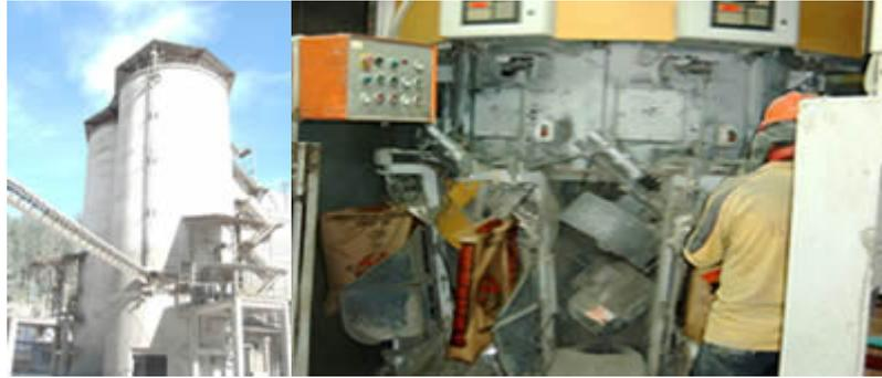
El área está equipada con dos líneas completas de enfundado del cemento con ensacadoras rotativas Haver Boecker con 8 bocas cada una y una capacidad de enfundar 2500 sacos/hora cada máquina. Con servomecanismos automáticos que permiten un flujo continuo y estable en la emisión de sacos. Paralelamente para el despacho a granel se dispone de dos sistemas de alimentación para carros cisterna.
