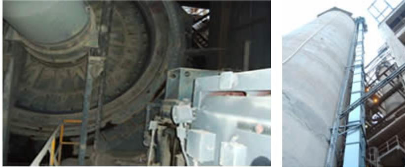
Se realiza la molienda hasta una finura tal que el retenido en el tamiz de 200 ASTM (75 micras) sea menor al 15 %, con una humedad del producto menor al 0,5 %. El equipo principal es un molino de bolas horizontal, marca Fuller Co con capacidad de 90 TMPH, consta de una cámara de admisión y secado y dos cámaras de molienda con descarga central periférica y un circuito de recirculación de material con separadores de tamaño de partícula tanto estáticos como dinámicos.
