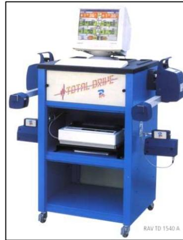
Especiales soportes a los lados de la consola permiten el alojamiento y la carga de las baterías de los detectores cuando no se utilizan. La comunicación con el usuario está constituida por el teclado: además los mandos se pueden efectuar directamente desde los detectores mediante los relativos teclados de función.
