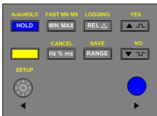
Los botones pulsadores se utilizan para incrementar la capacidad de la función seleccionada con el selector giratorio.
