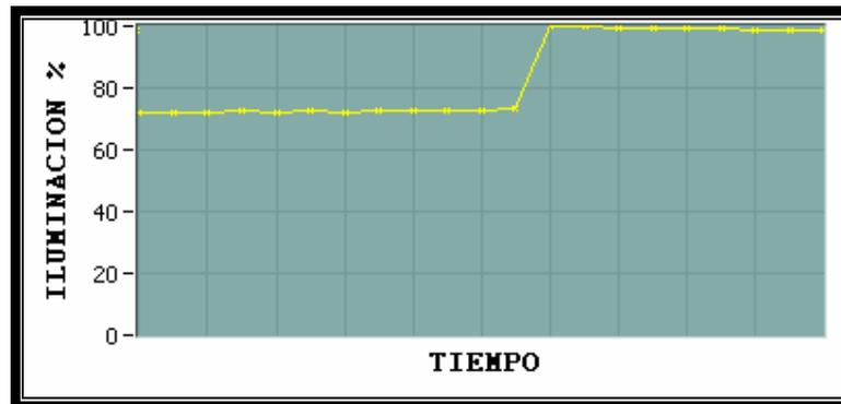
**Figura 4.7.** Gráfico de respuesta al impulso del sistema de Iluminación.
