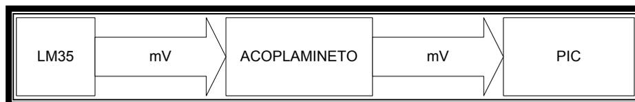
**Figura 4.15.** Diagrama de bloques del funcionamiento del sensor de temperatura.
