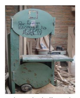
La sierra cinta se encarga de cortar las plantillas trazadas en la madera según el molde diseñado, y de esta forma prepara la madera para el siguiente proceso.
