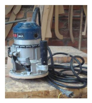
El Router sirve para perfilar las piezas de madera.
