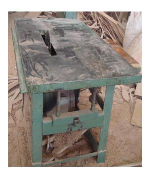
La sierra circular sirve para realizar los cortes rectos en la madera, lijar piezas cambiando la sierra por una lija y para realizar las perforaciones en las piezas.
