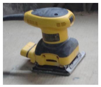
La Lijadora de Palma se encarga de preparar la madera para el lacado, ya que con esta máquina la madera queda liza.
