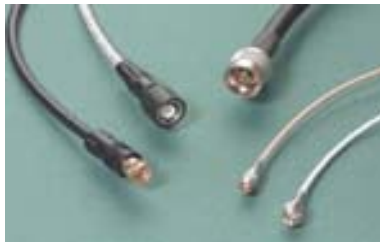
FIG.12 CABLE COAXIAL www.uleam-facci.com/archivos/1114552459Cableado-estruct
