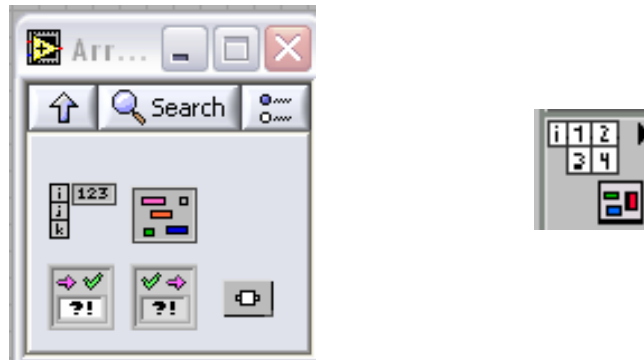
fig 3.94 Controles de array y clusters
