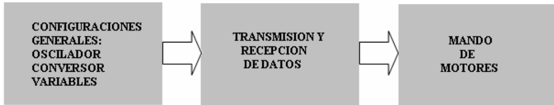
fig3.83 Diagrama de bloques del programa del microcontrolador
