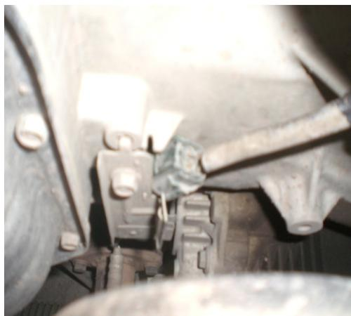
**Figura 23. Conector de sonda roto**
