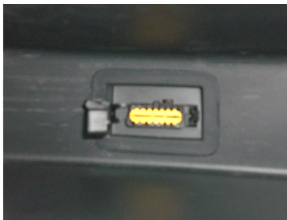
**Figura 64. Conector del vehículo Renault Logan**
