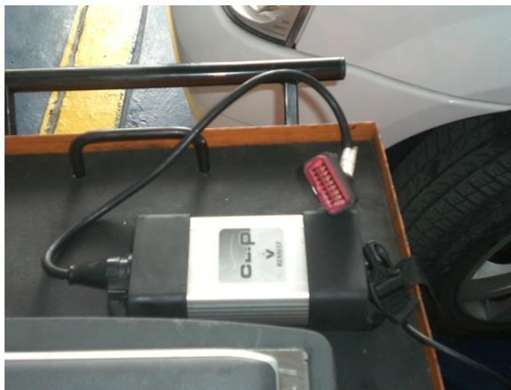
**Figura 63. Sonda de comunicación**
