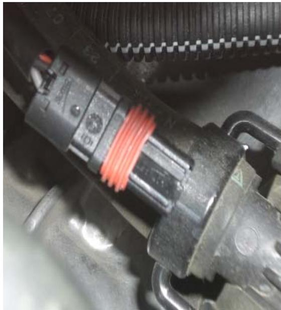
**Figura 80. Sensor de temperatura**
