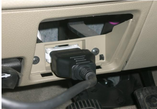
**Figura 47. Conector del vehículo Nissan Tiida**
