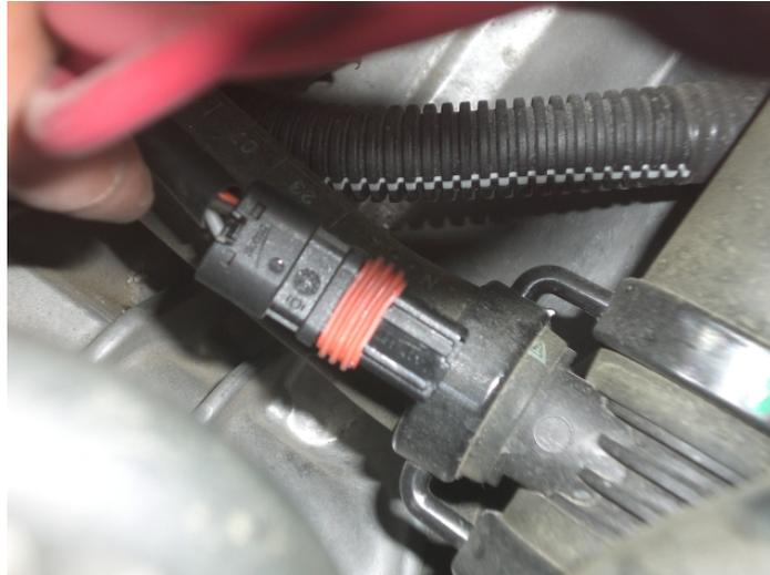
**Figura 82. Revisión de sensor de temperatura**
