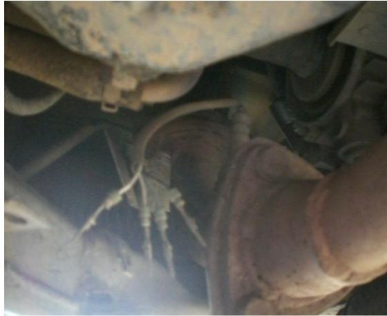
**Figura 21. Sonda en mal estado**
