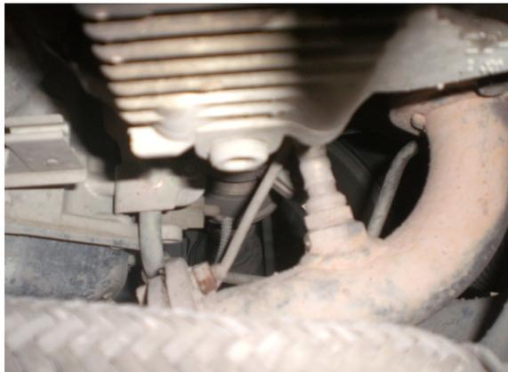
**Figura 25. Posición correcta de sonda en el colector de escape**
