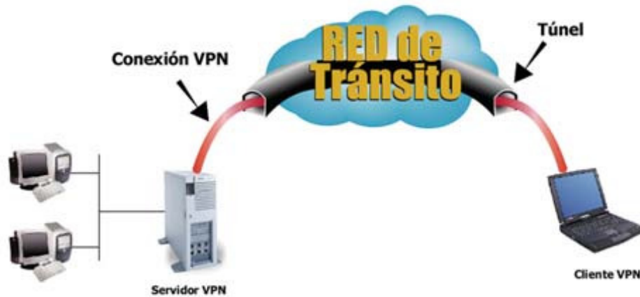
Fig 2.2 Estructura de VPN
