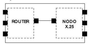
Como se puede ver en la figura cada equipo virtual gobierna su propio conjunto de interfaces. Es necesario pues poder identificar de forma precisa los distintos interfaces y saber si un interfaz pertenece al router o al nodo.
