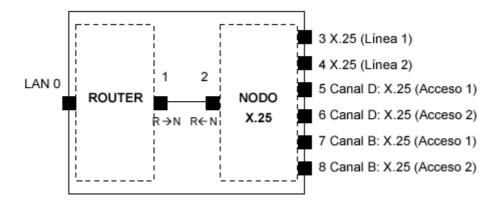
Suponga ahora que se cambia el protocolo de una de las líneas WAN mediante el comando **SET DATA-LINK** y que a continuación se consulta la tabla de interfaces. En el siguiente ejemplo se asigna a la línea física 2 el protocolo Frame Relay:
