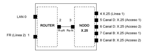
Los interfaces RDSI pueden aparecer tanto gobernados por el nodo como por router, en función del tipo de información que se transporte por el canal B. Si se trata de X.25, como en los ejemplos previos, los interfaces RDSI aparecen del lado del nodo. Si se trata de PPP o de backup de Frame Relay, aparecerán del lado del router. El X.25 por canal D está siempre en la parte de nodo.
