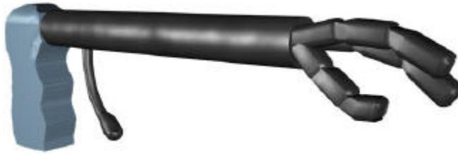
Es la parte principal del objeto, consiste en el brazo, mango y palanca, es lo que esta en contacto con el usuario, y la parte donde resiste el peso de los objetos agarrados.
