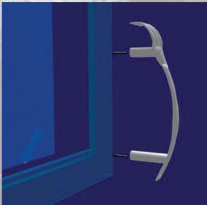
CUBIERTO DEFORMADO Y CONVERTIDO EN MANIJA QUE SE SUJETA AL MARCO DE MDF POR MEDIO DE TORNILLOS QUE TRASPASAN LA MADERA Y SON ASEGUADOS CON TUERCAS.
