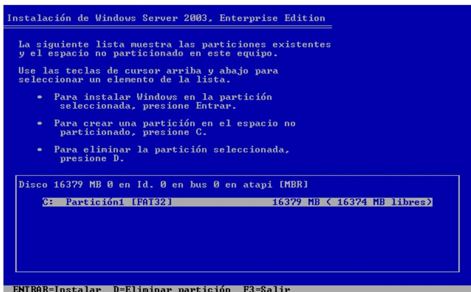
Figura 3-19 Selección de la partición en la que se instalará el sistema operativo.
