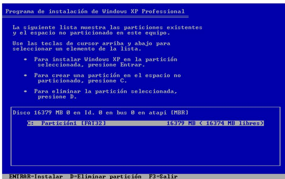
Figura 3-2 Selección de la partición en la que se instalará el sistema operativo.
