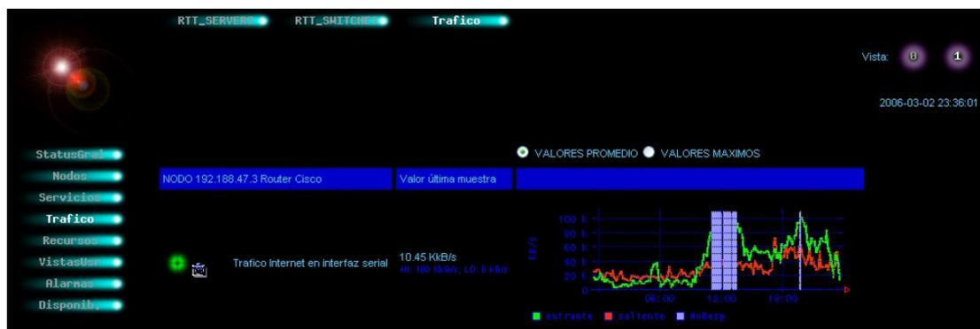
**Figura 1-6** Vista 1 Tráfico de Internet en interfaz serial
