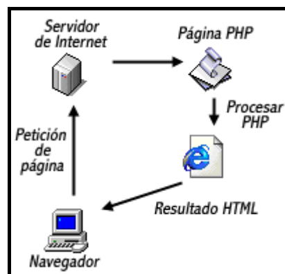
Figura 1.3: Diagrama de la solicitud de datos y ejecución del lenguaje PHP.
