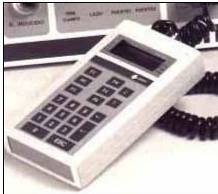
**Figura 5.1.2.5** Consola de programación portátil
