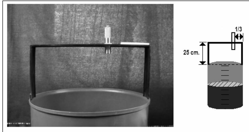
**Figura 7.2.2 Posición del sensor en el puente**
