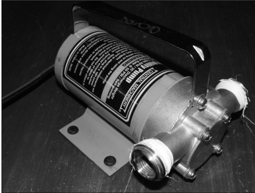
Figura 7.1.4 Bomba de agua, elemento final de control
