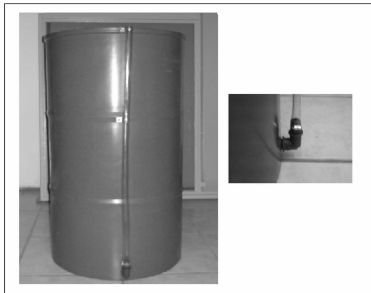
**Figura 7.2.3 Visualización del nivel de líquido para el tanque (1)**
