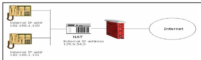
Figura 11: Teléfonos IP detrás de un NAT y un Firewall
