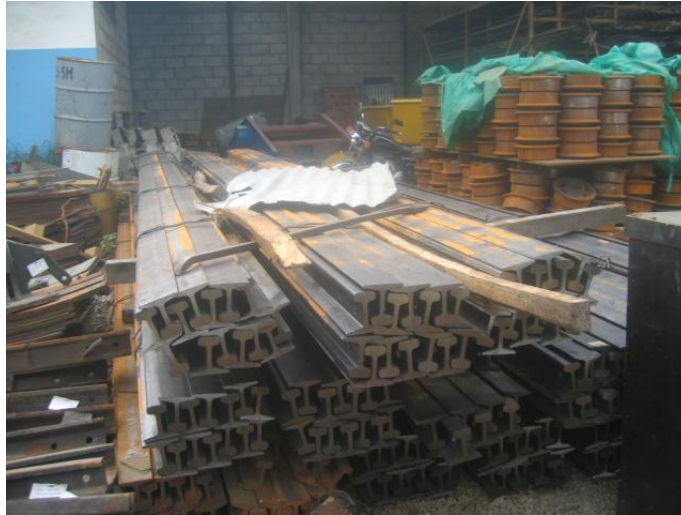
Figura N.- 43 Rieles para mina Fuente Franklin Pacurucu
