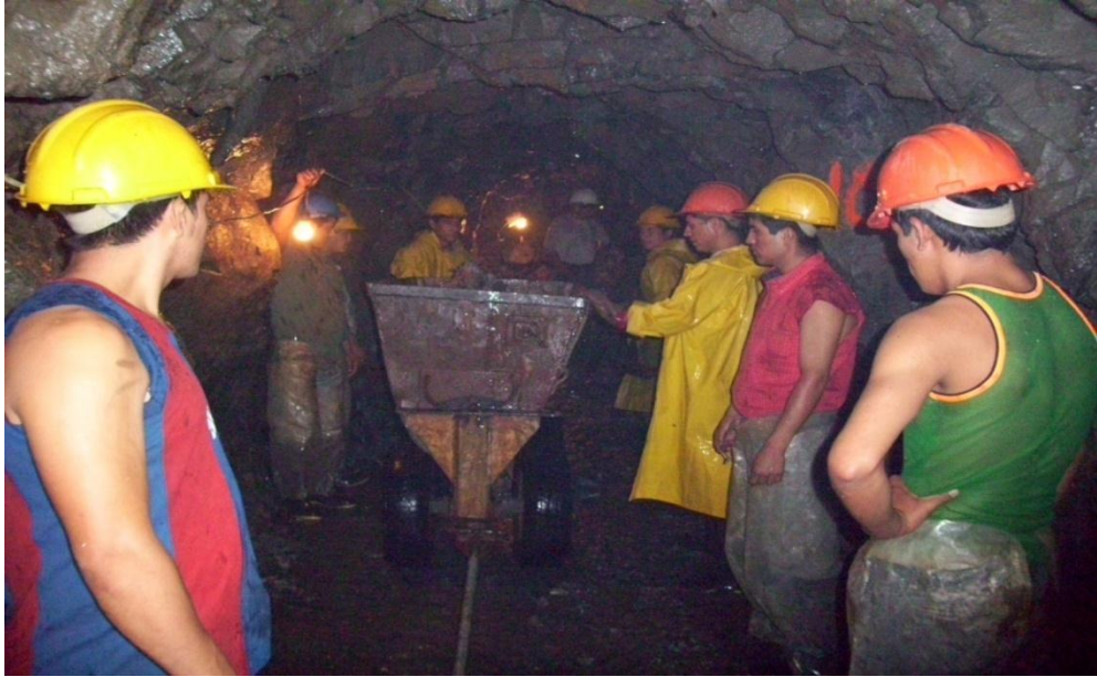
Figura N.- 16 personal para desalojar la cuña (exceso de personal) Fuente: archivo de la empresa
