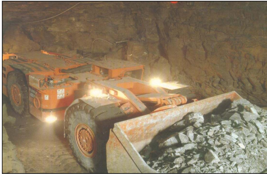
Figura N. 20 Equipo LDH en operación, en una mina subterránea Fuente: Oyarzun R. Sistemas de explotación 2005
