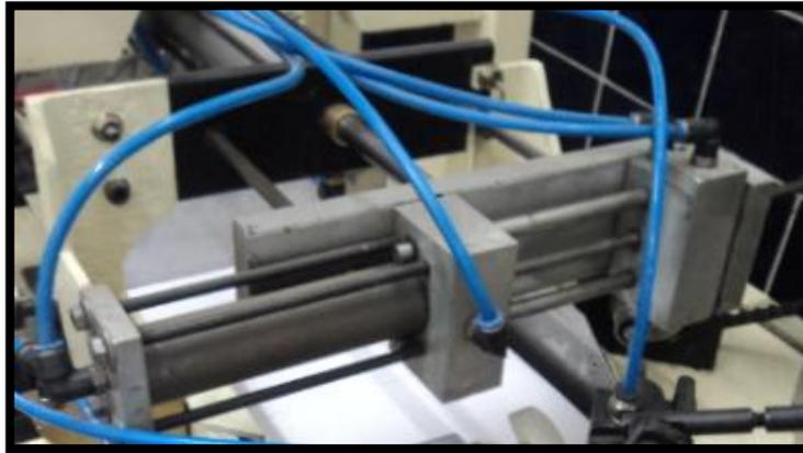
Figura 5.10 Pistones del dispositivo de traslado de papel
