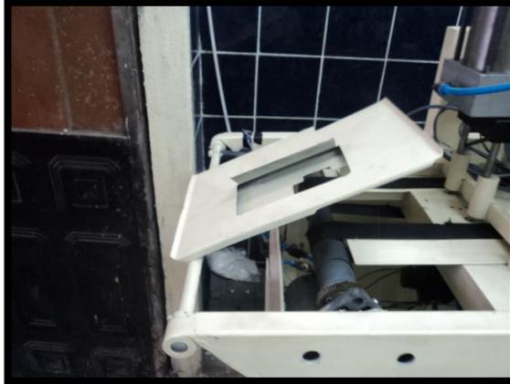
Figura 5.12 Bandeja que levanta paquete y lo alinea hacia la enfundadora
