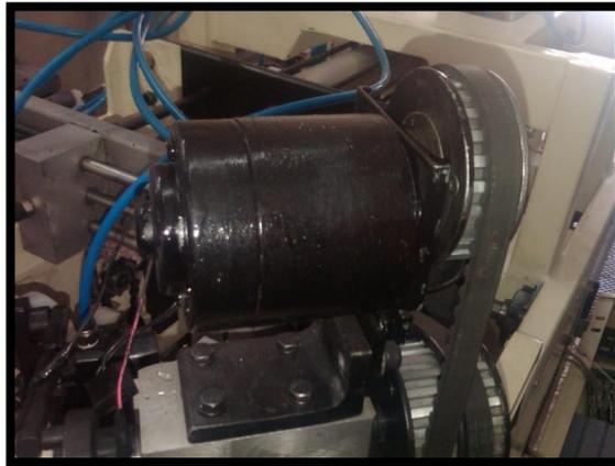
Figura 3.1 Motor de Corriente Continua para conteo de hojas
