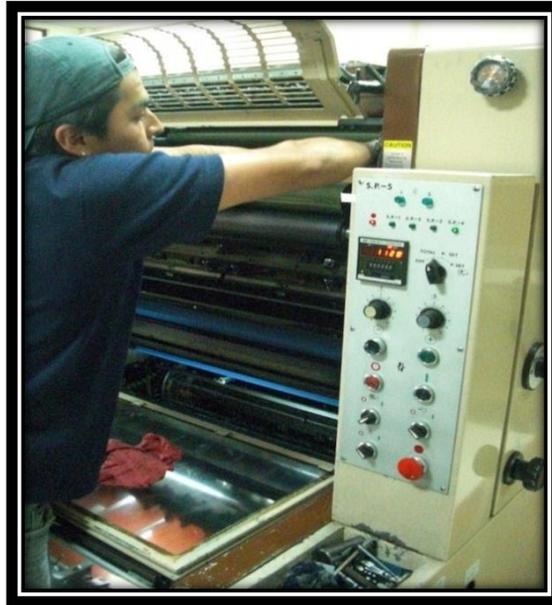
Figura 1.7 Colocación de la plancha CTP en la maquina offset
