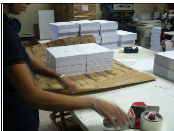
Figura 2.3. Empacado y sellado del paquete
