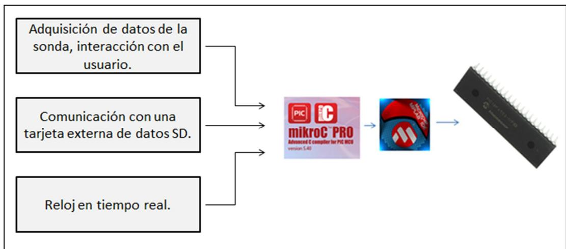
Figura 1. Diagrama de bloques de partes del software en MikroC PRO
