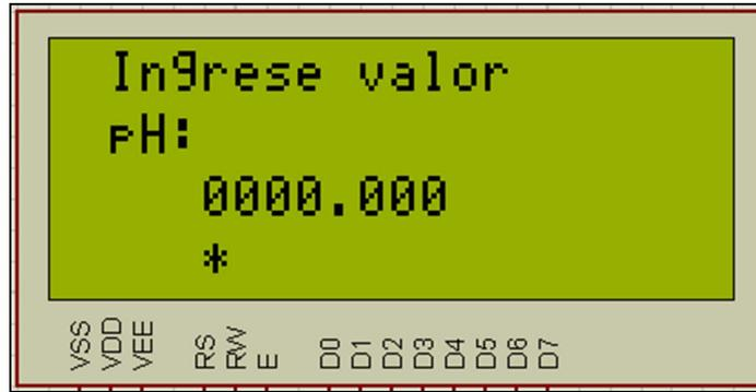
Fig. 10.3.1 Pantalla de calibración de pH de 1 punto.
