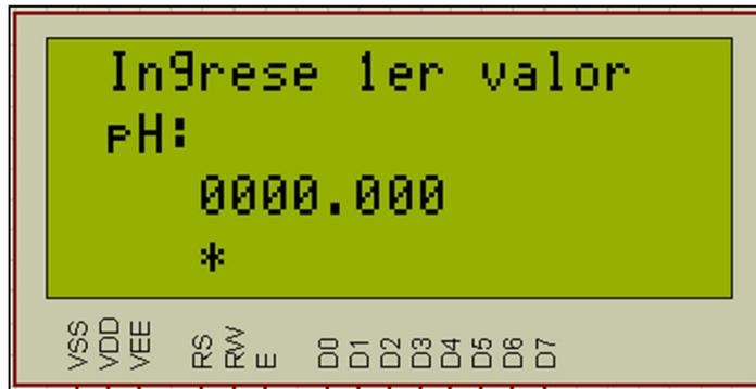
**Fig. 10.3.3** Pantalla de calibración de pH de 2 puntos (primer punto).
