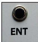
El botón “Ent”, abreviación de Enter. Este nos permite ingresar a cualquier menú o submenú previamente seleccionado con el símbolo “\*”, además este botón es utilizado en la configuración de valores, este botón nos permite cambiar el valor de un dígito, es decir cambia el valor de 0 a 1 o de 1 a 2 y así sucesivamente. Para la configuración de valores, cada dígito solo subirá su valor.
