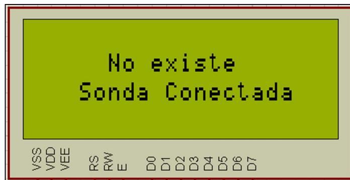
Fig. 6.2.2 Impresión del mensaje "No existe sonda conectada", en el LCD.
