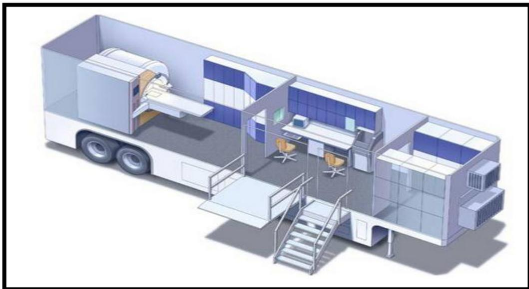
**Figura 2.83** Resonador Magnético Móvil.
