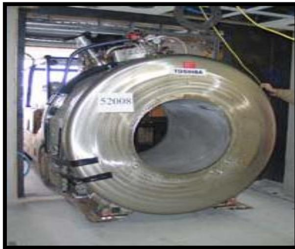
**Figura 2.29:** Electroimán Superconductor más usado en IRM.
