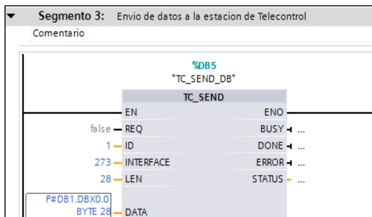
**Figura 3.31:** Configuración de la instrucción TC\_SEND para el envío de los parámetros.
