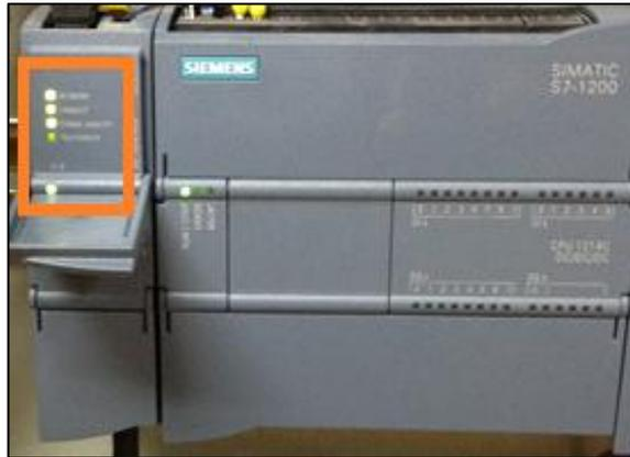
**Figura 4.16:** Estado de los LEDs del módulo cuando se ha establecido la comunicación.
