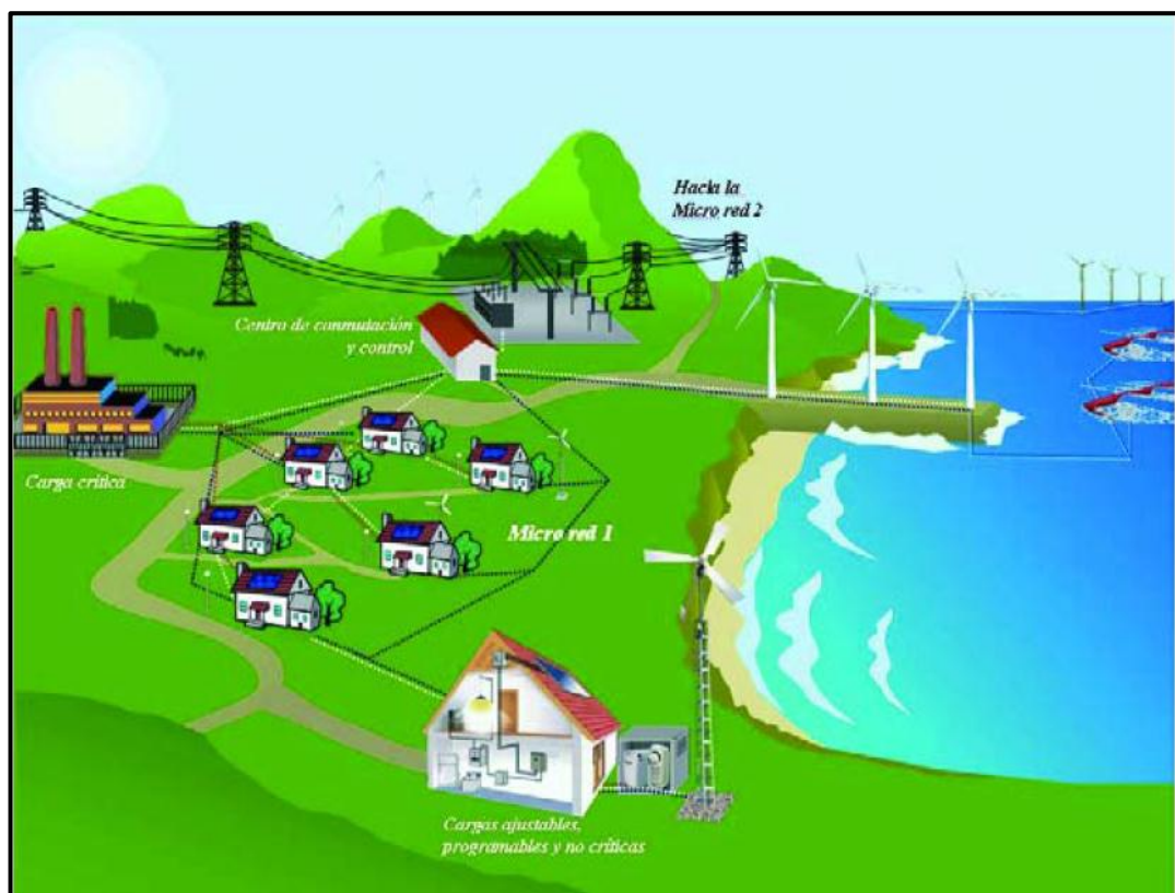
Figura 1.1 Ejemplo de aplicación de GD en un sistema eléctrico. (FENERCOM. Guía Básica de la Generación Distribuida, Pág. 9)
