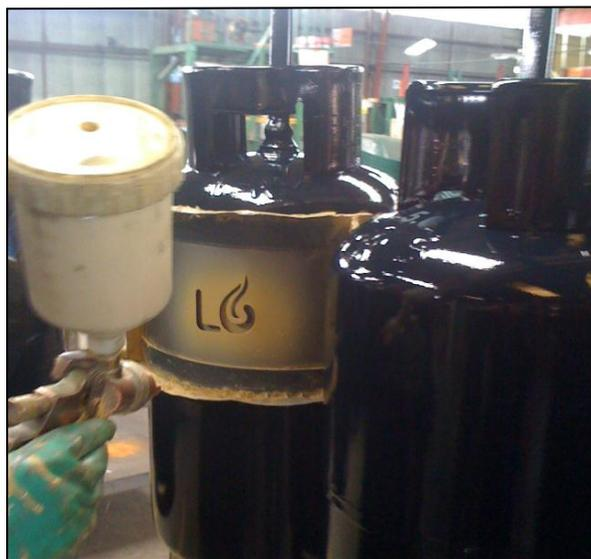
**Figura 1.11.** Impresión de la Tara en el cilindro de GLP.
