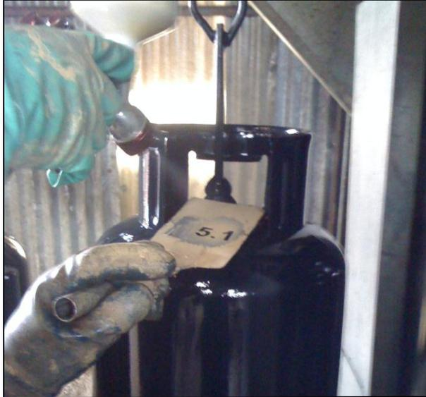
**Figura 1.10.** Impresión de la tara en el cilindro de GLP.
