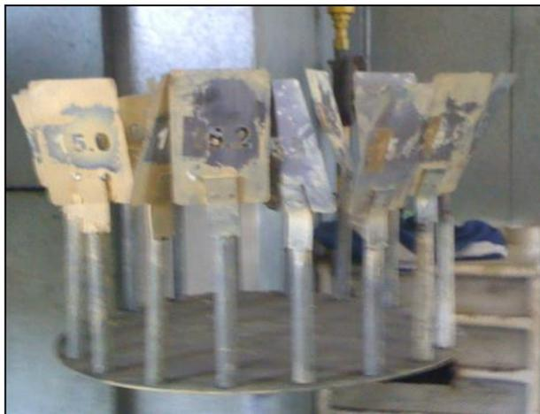
**Figura 1.9.** Plantillas para el pintado de la tara en el cilindro de GLP
