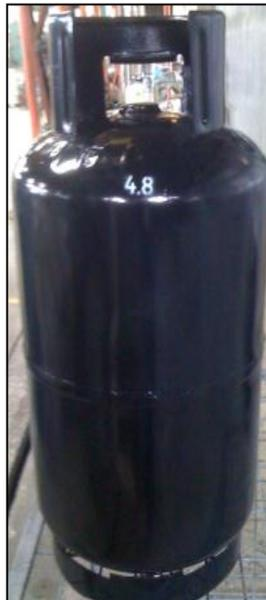
**Figura 1.1.** Tara del cilindro de GLP.
