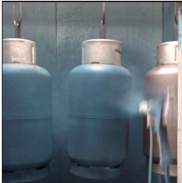
**Figura 1.7.** Rociado de pintura en los cilindros de GLP.
