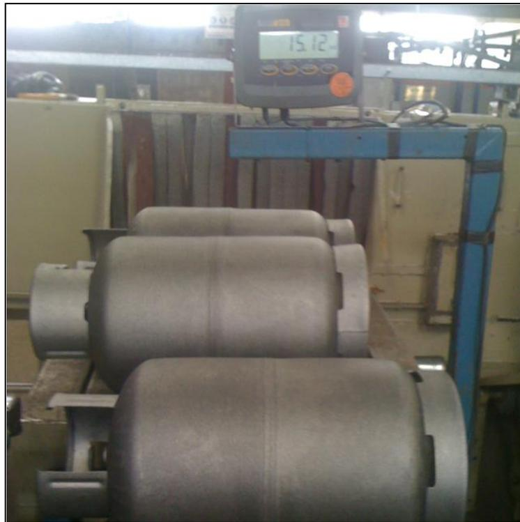
**Figura 1.5.** Pesado del cilindro de GLP.
