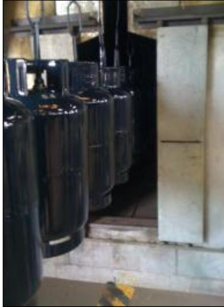
**Figura 1.8.** Salida de los cilindros de GLP del horno.
