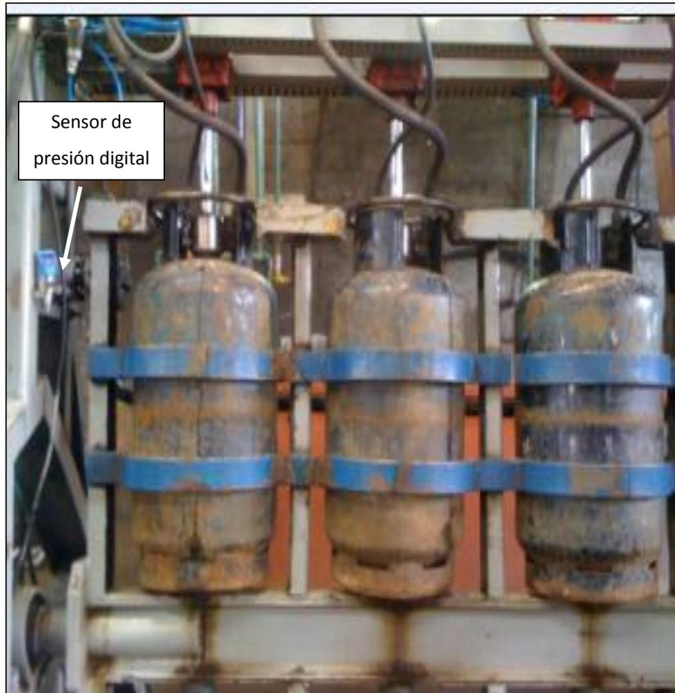
**Figura 1.4.** Pruebas de fuga del cilindro de GLP.
