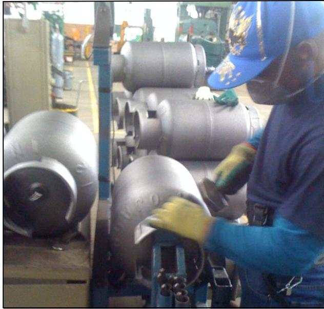
**Figura 1.6.** Marcado del valor del peso del cilindro de GLP.
