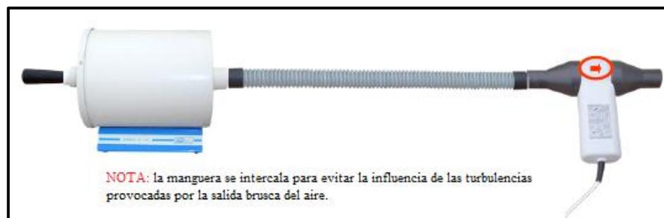
Figura-3.1.1- Conexión para Calibración (Fuente: Carruso Mariano, CALIBRACION DE ESPIROMETROS, 2)-consultado 4-marzo-2013)
