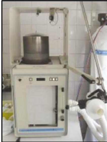
Figura-2.1.1-Espirómetro de Agua- (Fuente Carruso Mariano, Espirometria Transductores de Flujo, 5)- Consultado 6-Febrero-2013.)
