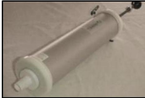
Figura-3.1.2- Jeringa de calibración de 3 litros. Este modelo lleva un pistón graduado que puede variar el volumen- (Fuente: Cimas, Pérez, Técnica e Interpretación de Espirometría en Atención Primaria-capítulo-3) -consultado 5-marzo-2013)
