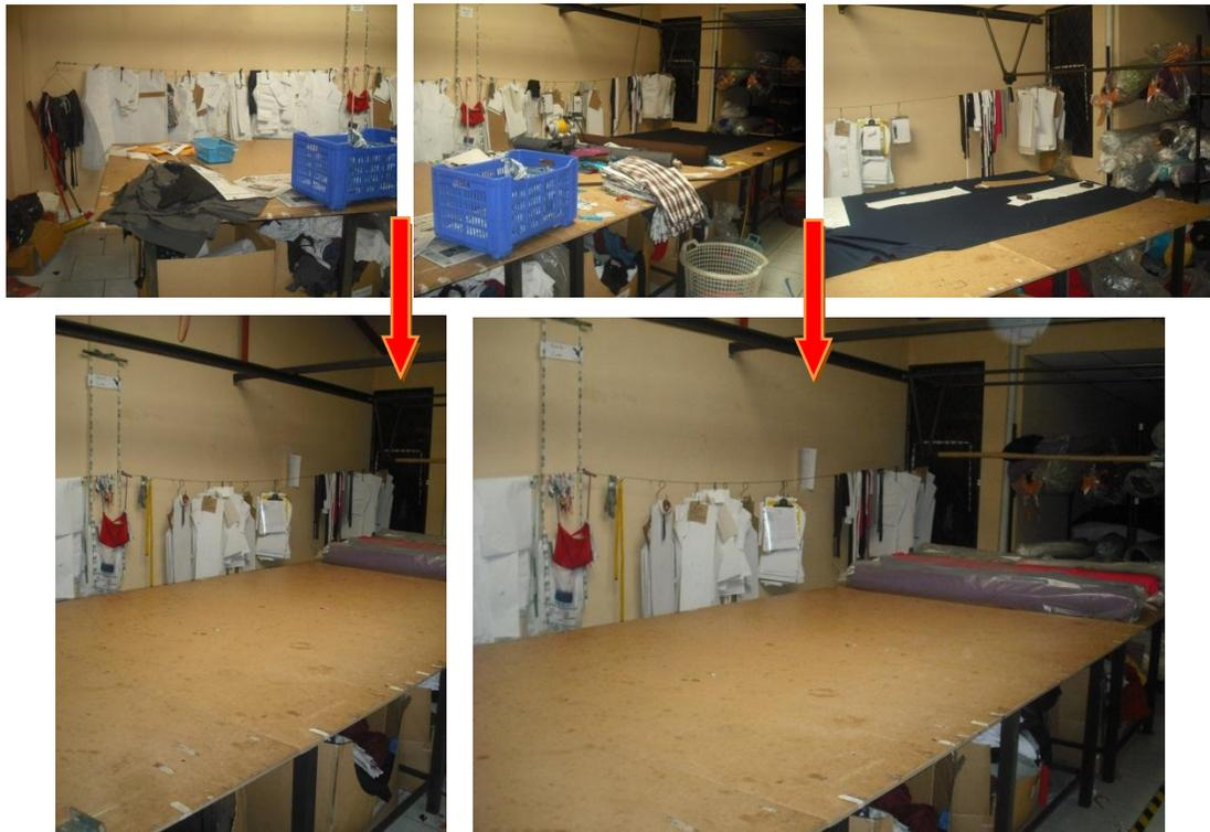
Figura 4.20: Mesa de corte antes y después de aplicar las 5 "S"
