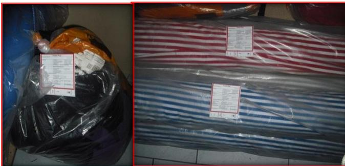
Figura 4.5: Materia prima que ya no se usa, en lugares que impiden la fácil circulación por el pasillo.
