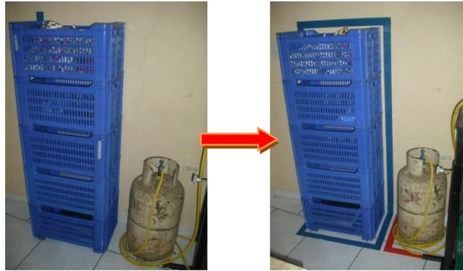
Figura 4.25: Canastas en un espacio designado correctamente señalado.
