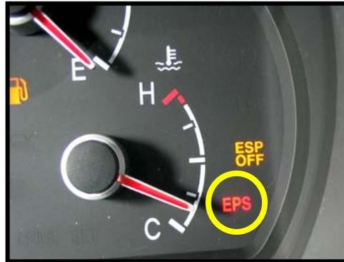
**Figura 1.20.** Testigo luminoso.
