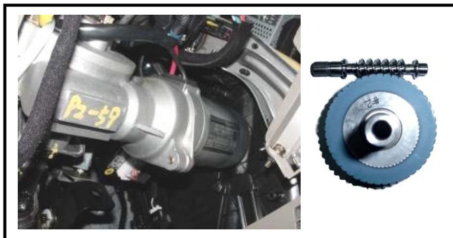
**Figura 1.14.** Acople del motor eléctrico a la columna.
