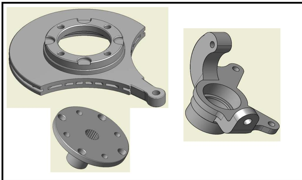
**Figura 2.17.** Elementos del freno.
