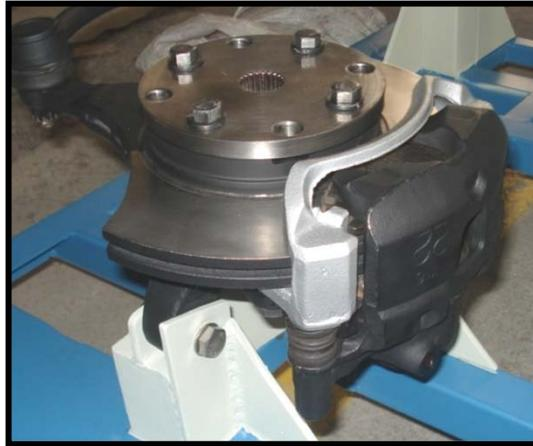
**Figura 2.22.** Freno ensamblado.
