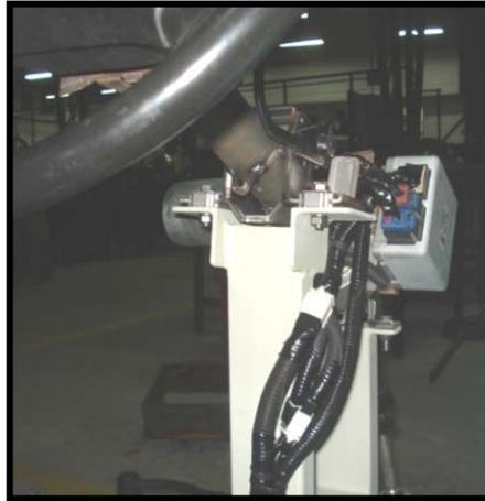
Figura 4.2. Conexiones de la columna de dirección.
