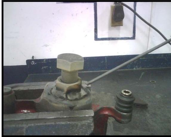
**Figura 2.20.** Soldadura de la tuerca del tornillo a la mordaza.
