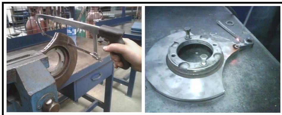
**Figura 2.19.** Soldadura de la articulación al disco.
