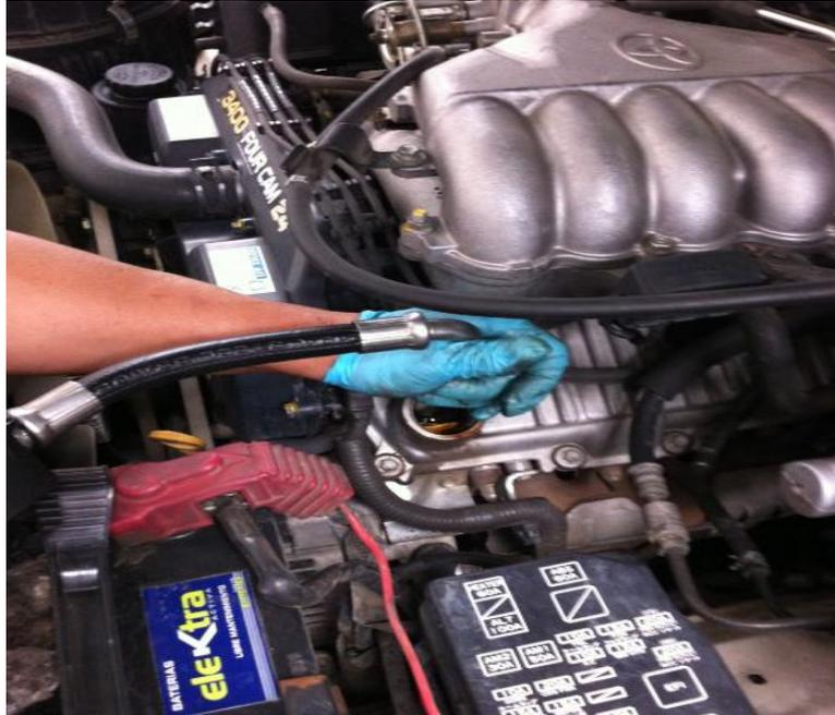
Figura 1.11 Colocación del aceite limpio en el motor
