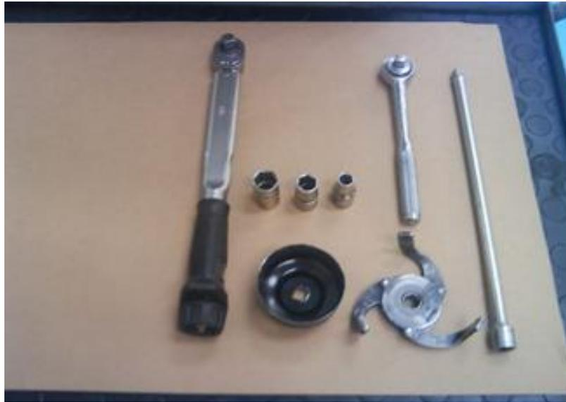
Figura 1.2 Herramientas necesarias para el cambio de aceite
