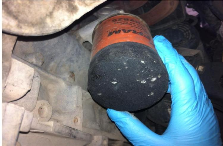
Figura 1.9 Instalación del filtro de aceite
