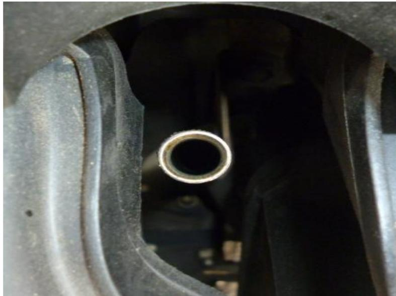
Figura 3.34 Medición del diámetro del conducto de la varilla del aceite del Toyota Yaris.
