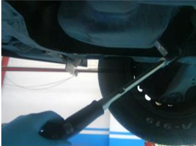
Figura 1.7 Instalación y apriete del tapón del cárter
