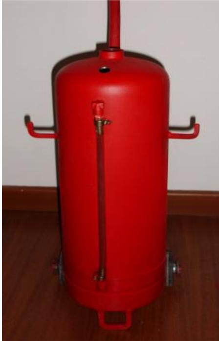
Figura 3.43 Colocación del medidor de nivel de aceite.
