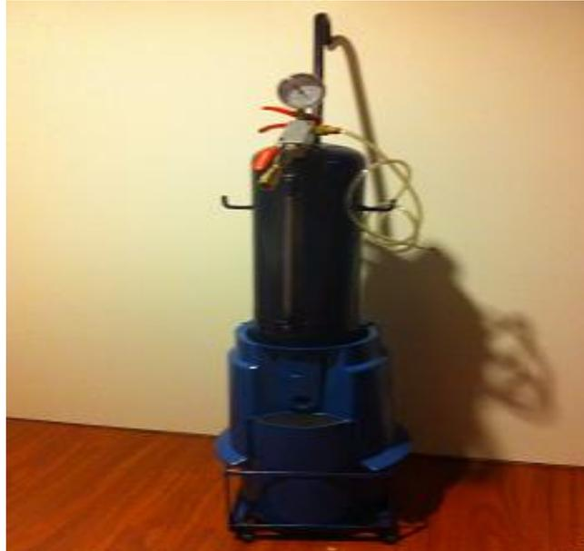
Figura 3.49 Aspirador de aceite armado.
