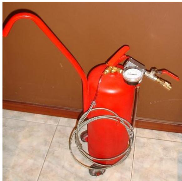
Figura 3.48 Resultado final de la construcción del aspirador de aceite.
