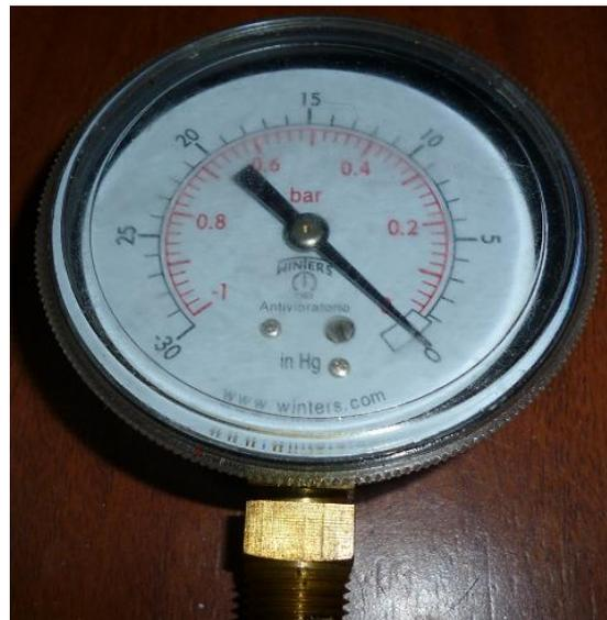
Figura 3.31 Vacuómetro de vacío.
