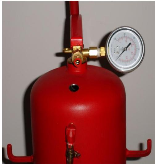
Figura 3.45 Instalación de la válvula en el cilindro.
