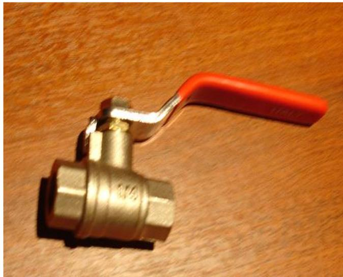
Figura 3.18 Llave de regulación de la presión de entrada al aspirador
