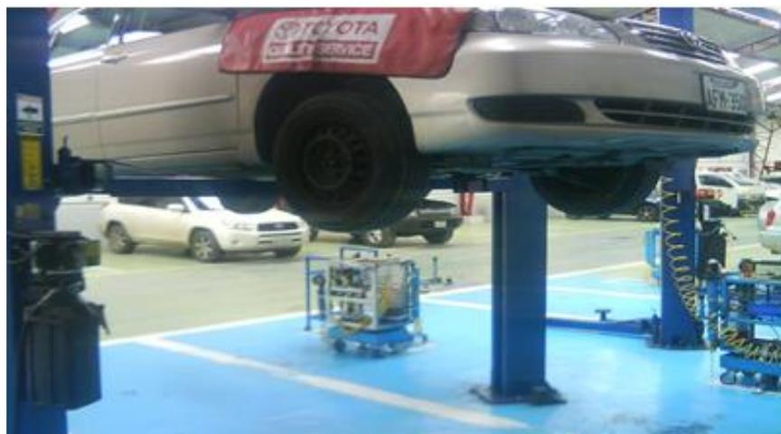
Figura 1.4 Elevación del vehículo a la posición de 1.5m
