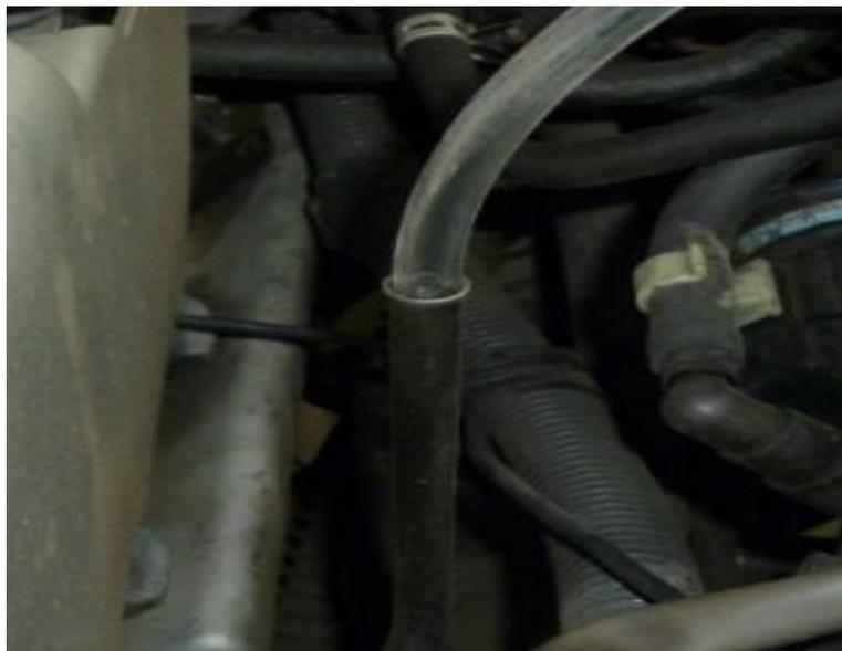
Figura 3.37 Medición del diámetro del conducto de la varilla del aceite del Land Cruiser 100.
