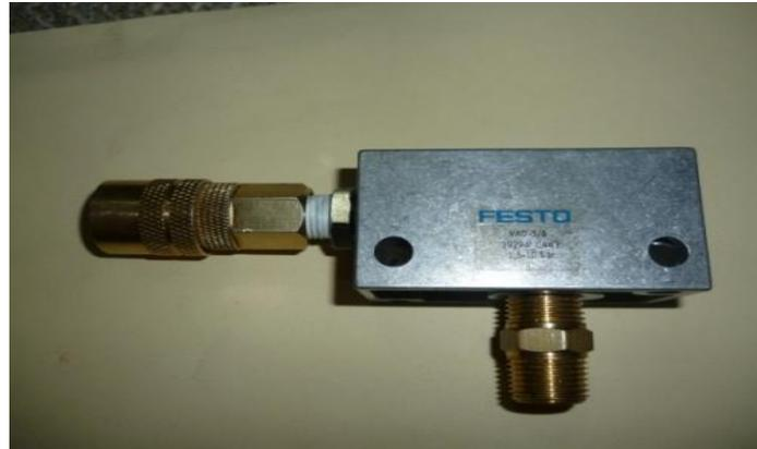
Figura 3.47 Instalación de un acople de 3/8 NPT x 3/8 NPT a la tobera.
