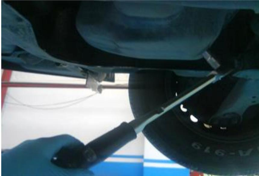
Figura 1.5 Desinstalación del tapón de aceite
