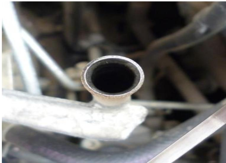
Figura 3.35 Medición del diámetro del conducto de la varilla del aceite de la Toyota Hilux con motor 2KD.
