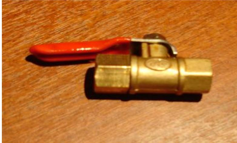
Figura 3.39 Válvula de descarga de aceite.
