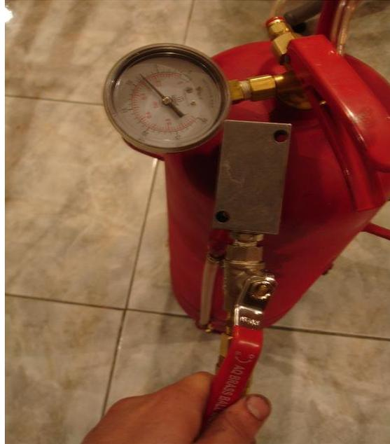
Figura 4.52 Inspección de vacío mayor a  $-0,3$  bar para iniciar extracción.
